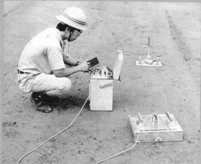
⑥ RI による打設コンクリート密度測定
