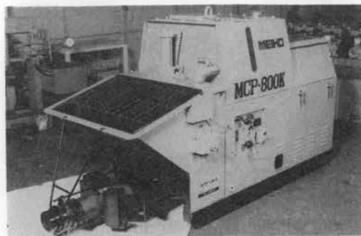
写真-11 ワキタ MCP-800 K コンクリートポンプ
