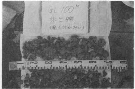
写真-7 GL-100 m 排出物 (粘土分が多い)
