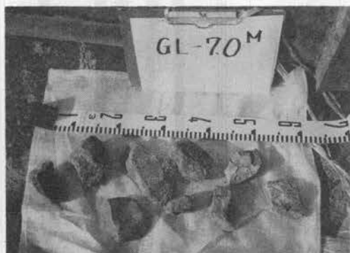
写真-4 GL-7m 排出れき
