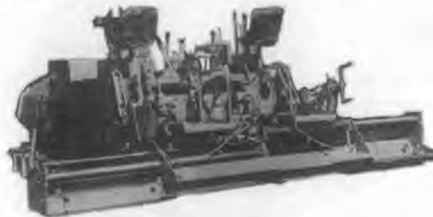
写真-10 新潟 LT 1100 ラックステンション付フィニッシャー
