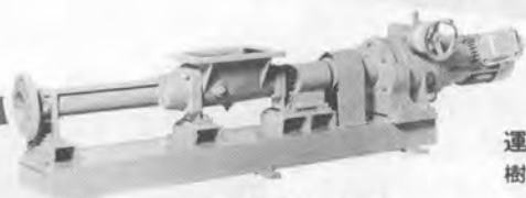
泥土のずり出し用 NES型
