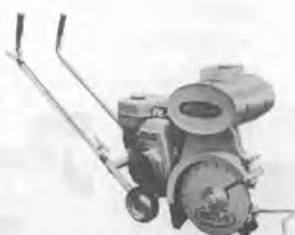
DCC-OR型 軽量型4PS 切断深 10cm 重量 38kg
