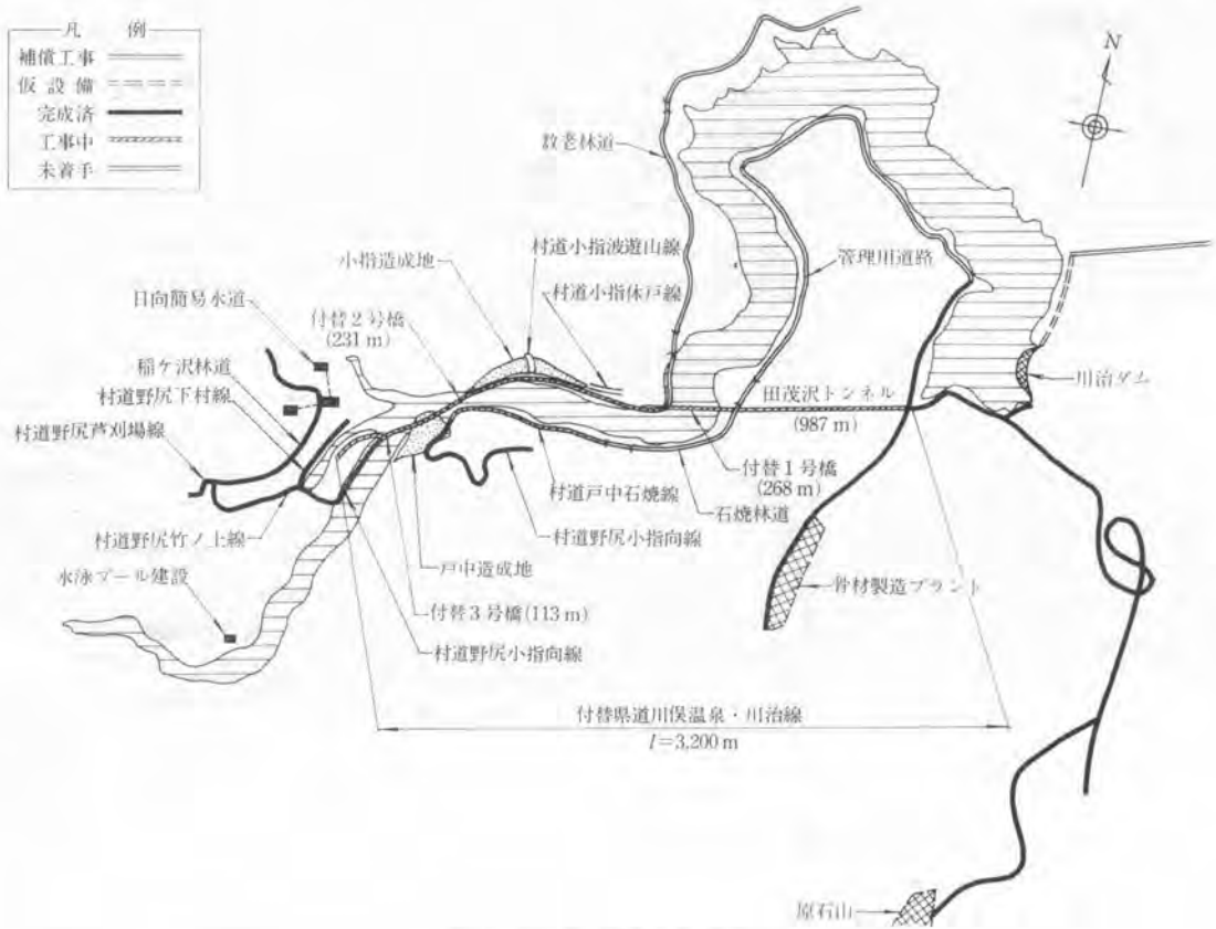
図-6 川治ダム工事実施概要図
