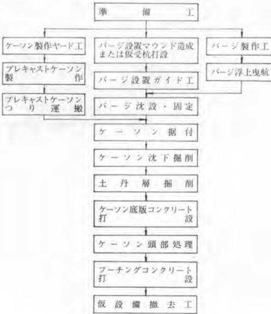
図-11 多柱基礎施工フロー
