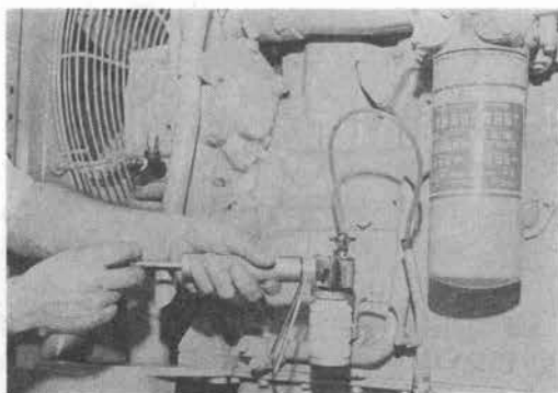
写真-4 分析用オイルの採油状況
