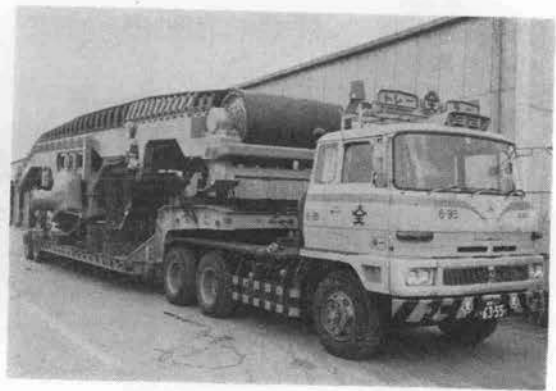
写真-6 分解運搬中のロックベルトローダコンベヤフレーム
