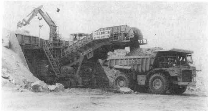
写真-1 45 t 積重ダンプに積込中のロックベルトローダ R-BCL-2500 B (右側)
