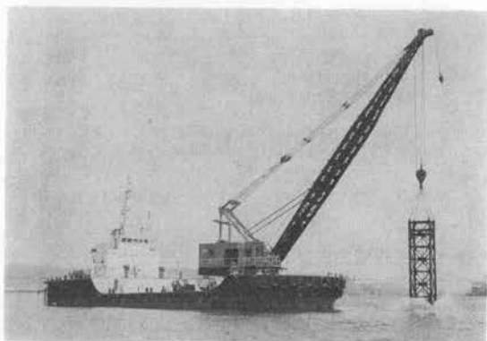
写真-9 神戸 F&G-1000 クレーン・グラブ 兼用作業船(自航式)
