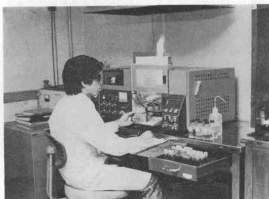
写真-1 原子吸光分光光度計によるオイル分析
