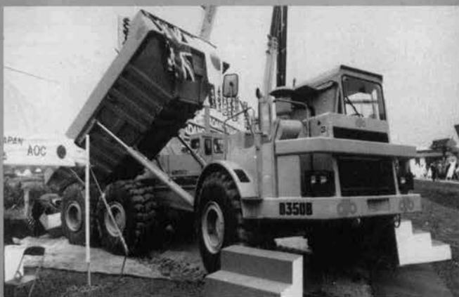
キャタピラー社のコンポーネントを使って 組立てられたアーティキュレートダンプ トラック D 350 B (20t積, 運転席は前後向切替 式, アジアオーバーシーズコーポレーション)
