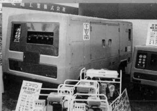
㊦低騒音型スクリーコンプレッサ PDS 600 S (17 m 3 /min, 北越工業)
