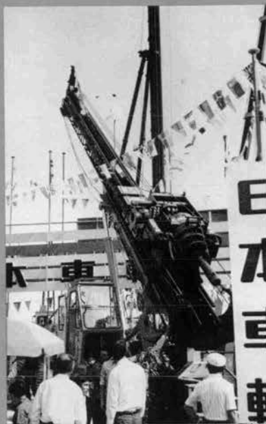
◆輸送、狭小現場での使用を考え小型化、低騒音化を図ったミニ杭打機DHJ-30 (日本車輛)
