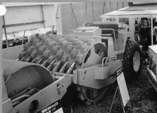
振動式タンピングローラ・ダイナバ ック CA 25 PD (12.2t, 三菱商事)
