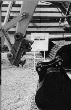
◆バケット着脱を簡単に行える クイックキャッチャ付 MS110 (0.4 m 3 , 三菱重工)
