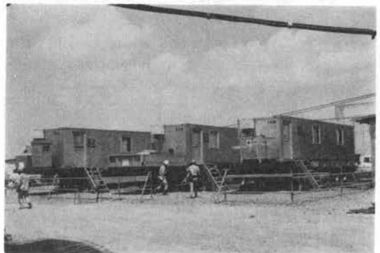
(多測点同時観測，リアルタイムでの波形解析プログラマなどを搭載，電力中央研究所で試作実用中)
