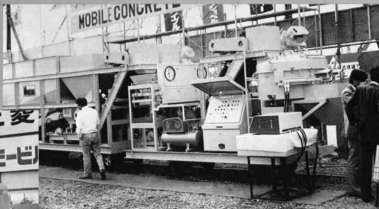
トンネル用コンクリート プラント MCP-120 P-BN (7.2m 3 /hr, 丸友機械) ㊦
