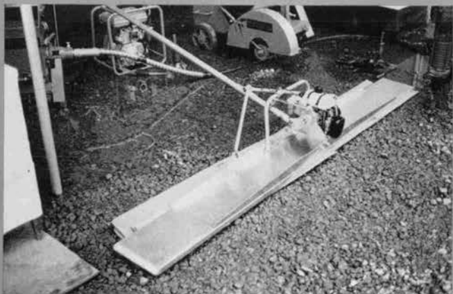
㊦エンジン式コンクリート仕上げ機 コンクリートタンバ IM 25 T (板橋機械)
