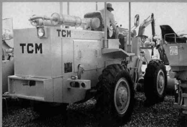
◆エンジンルームを密閉した低騒音型 トラクタショベル STD 30 (1.0m 3 , 東洋運搬機)
