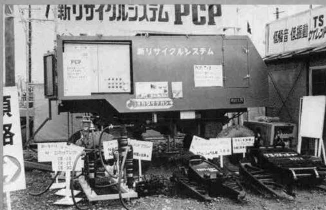
㊦ポータブル式コンクリートクラッシングプラント SC-6153 (60 m 3 /hr, オカダ鑿岩機)
