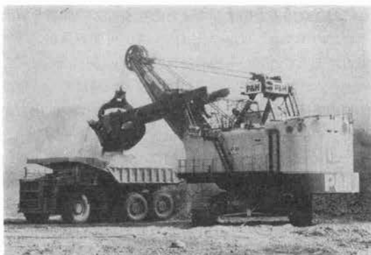
写真-1 マウントニューマン鉱山(オーストラリア)で活躍する P & H 2800 型電気ショベル
