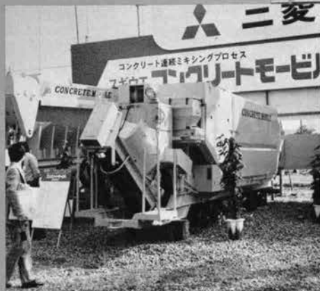
連続式ミキシング式コンクリート モビル CM 100 T (10m 3 /hr, 三菱商事)
