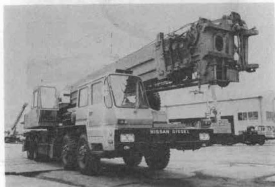
写真-4 神戸 T 450 II 油圧式トラッククレーン
