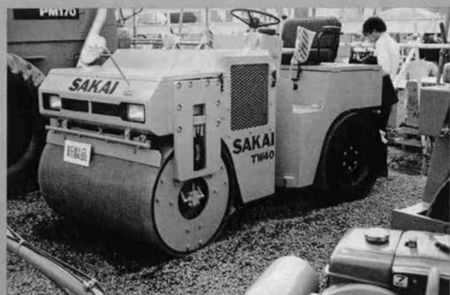
両輪駆動アーティキュレート式コンバ インドローラ TW 40 (3.5t, 酒井重工) ㊦
