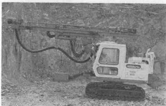
写真-6 東洋 THCD-500 油圧式クローラドリル
