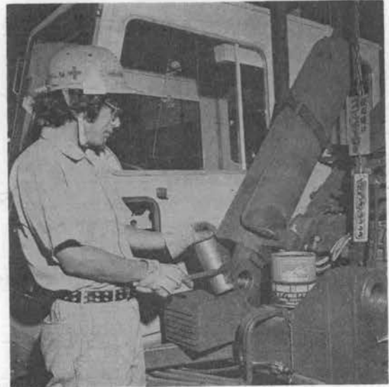
写真-4 トラッククレーンの油圧シリンダ固定ピンに極圧用グリース塗布
