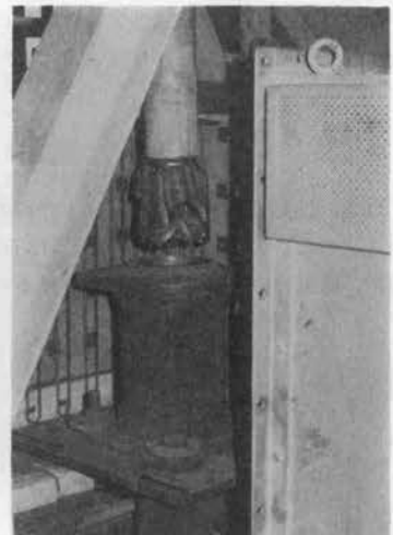
写真-4 ビット性能試験装置 (炉内状況)
