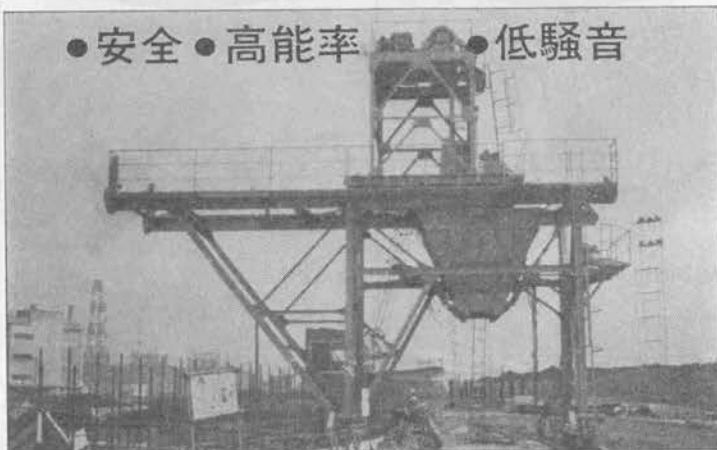
自動土砂排出装置(走行型・バケット4.8㎡付)
