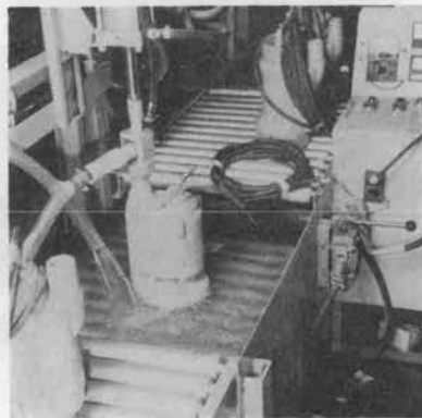
写真-2 水中ポンプ全数検査ライン
