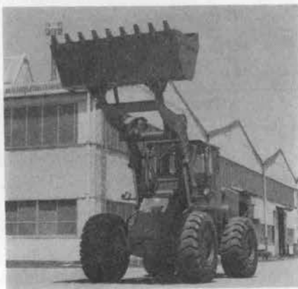
写真-6 古河 FL 320 A 車輪式トラクタショベル
