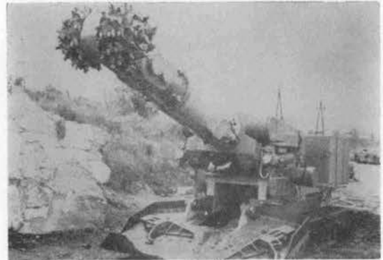
写真-1 アルピネ・マイナ AM 50 型ロードヘッダ
