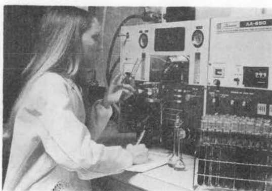
写真-3 使用オイルの分析による機械の健康診断
