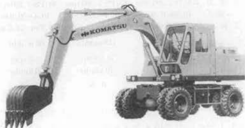
写真-4 小松 PW 100 油圧ショベル
