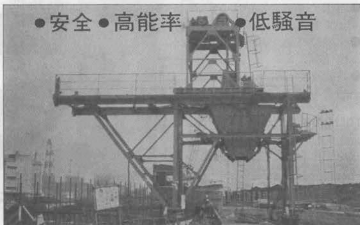
自動土砂排出装置(走行型・バケット4.8m²付)
