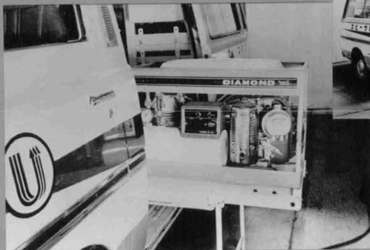
④ エンジン付ゼネレータとコンプ レッサ引出装置を架装した PM サービスカー (小松製作所)
