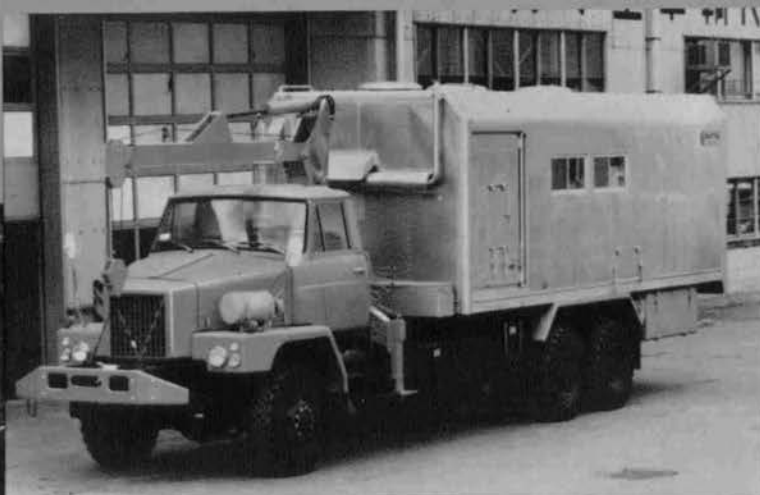
④ クレーン付大型工作車 (マルマ重車輛)
