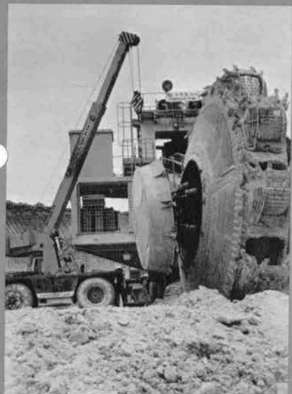
④ シンガポール/シンガポール東部海岸埋立第6期・7期工事/バケットホイールエキスカベータのバケットホイールの駆動油圧モータ点検, 整備 (大林組)
