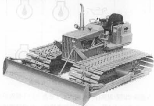
写真-1 小松 D 20 PLL-5 超々湿地ブルドーザ
