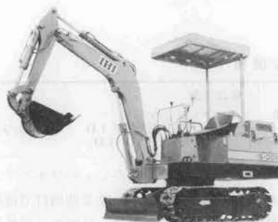
写真—5 石川島 IS-005 ミニバックホウ
