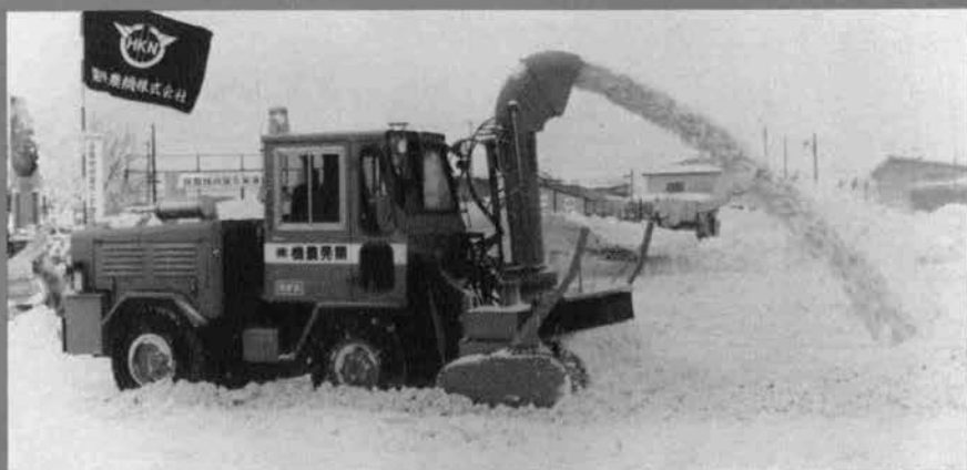
アタッチメント式ロータリ除雪車 開発農機 HK 130 (74 PS, 550 t/hr) 〔トラクタ: 50 PS〕
