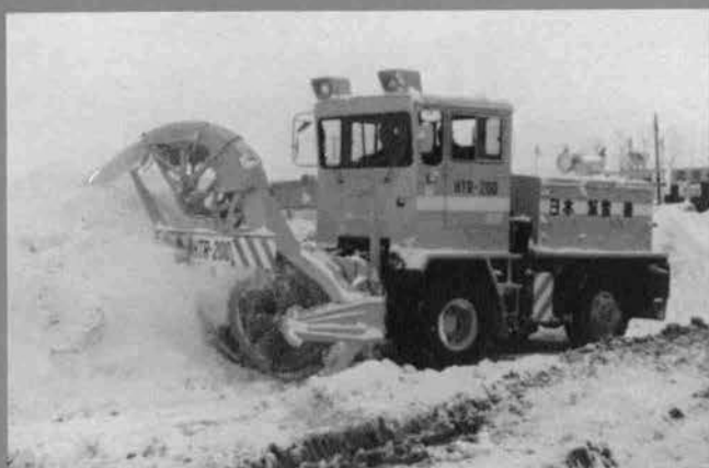
中型ロータリ除雪車 日本除雪機 HTR 200 (213 PS, 1,300 t/hr)
