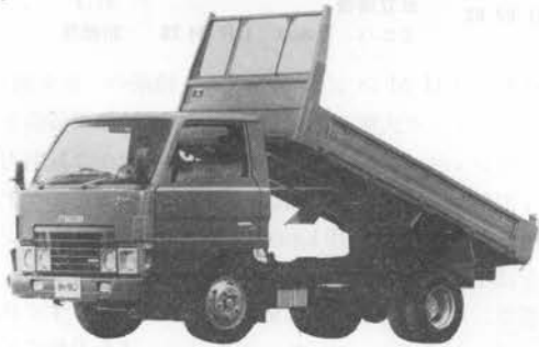
写真7 東洋工業 K-WEXO 11 D タイタン 4t 積ダンプトラック
