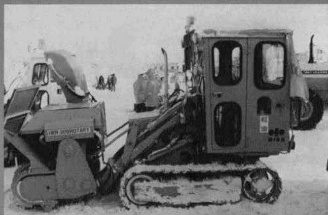
アタッチメント式ロータリ除雪車 開発農機 HK 130 (74 PS, 550 t/hr) 〔トラクタ: 50 PS〕
