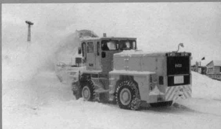
大型ロータリ除雪車 TCM R 400 (410 PS, 3,000 t/hr)
