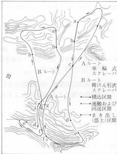
図-2 緑ヶ丘団地造成工事作業経路
