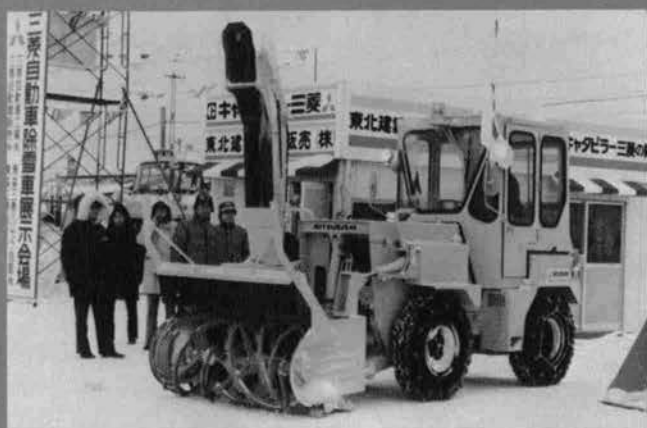
アタッチメント式ロータリ除雪車 三菱 WS 200 R (42 PS, 420 t/hr) ◆ 〔トラクタ: 三菱 WS 200, 25 PS〕
