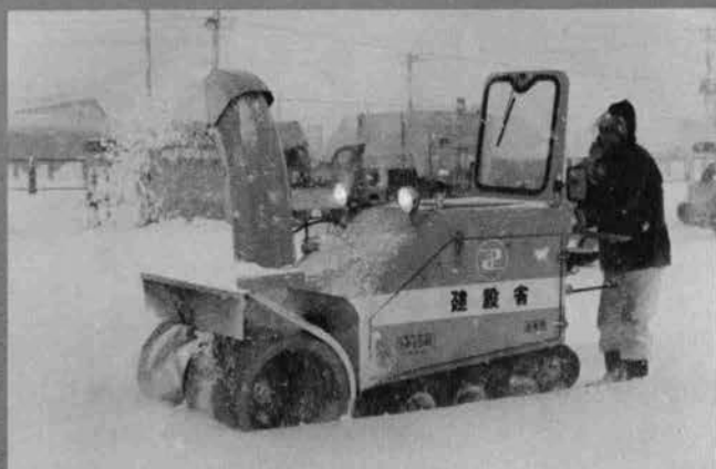
ハンドガイド式ロータリ除雪車 建設省東北地建製 SC-4 ◆ (30 PS, 160 t/hr)
