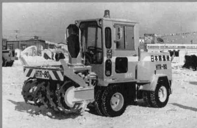
小型ロータリ除雪車 日本除雪機 HTR 80 (74.5 PS, 400 t/hr)
