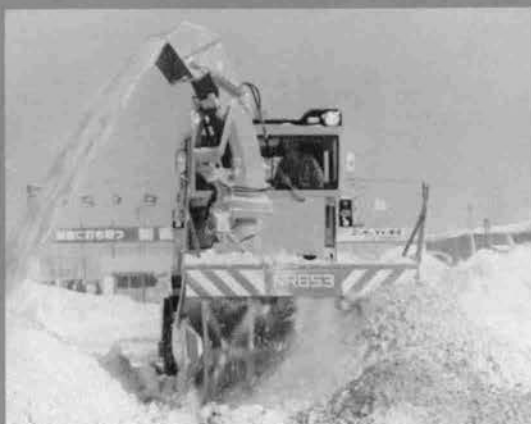
中型ロータリ除雪車・新潟鉄工 NR 653 (260 PS, 1,700 t/hr)
