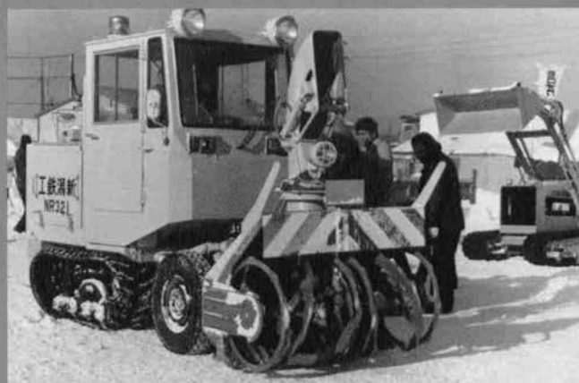
小型ロータリ除雪車 新潟鉄工 NR 321 (68 PS, 400 t/hr)
