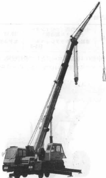
写真-7 神戸 T 250 M 油圧式トラッククレーン
