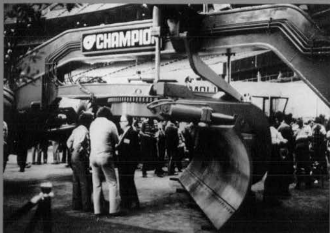
◇ Champion 100 T (出力 700 HP, 重量 91.6 t, ブレード長さ 24 ft, タイヤ 6 輪 (37.5 × 39))
