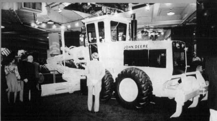
◇ John Deere 772 A モータグ レーダ (出力 150 HP)
