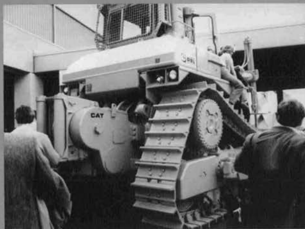
Caterpillar D 9 L ブルドーザ 〔出力 460 HP, 重量 58,072 kg (リップ付)〕
