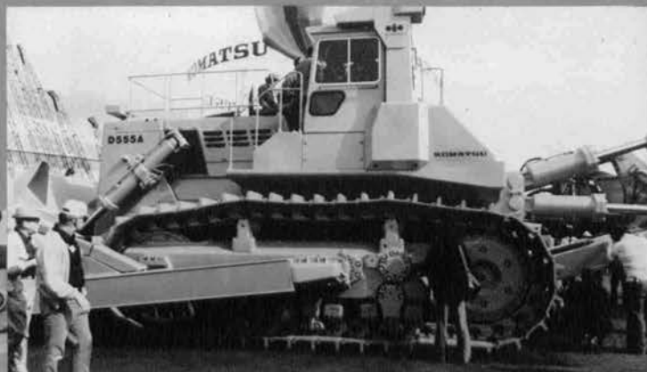
小松製作所 D 555 A ブルドーザ 〔出力 1,000 HP, 重量 120,000 kg〕
