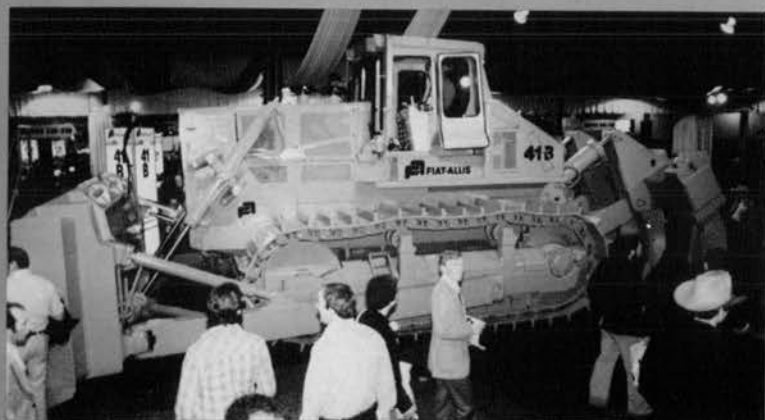
◇ Fiat Allis 41-B ブルドーザ (出力 524 HP, 重量 71,858 kg (リッ パ付))
