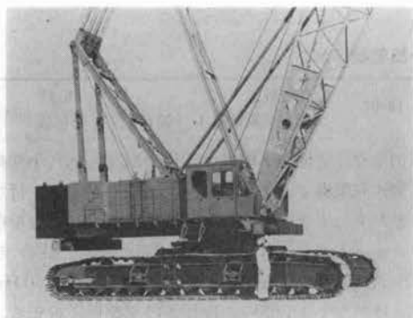
写真-9 石川島 CCH1500 全油圧式クローラクレーン
