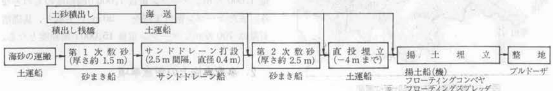
図-8 埋立地の施工フローの一例
