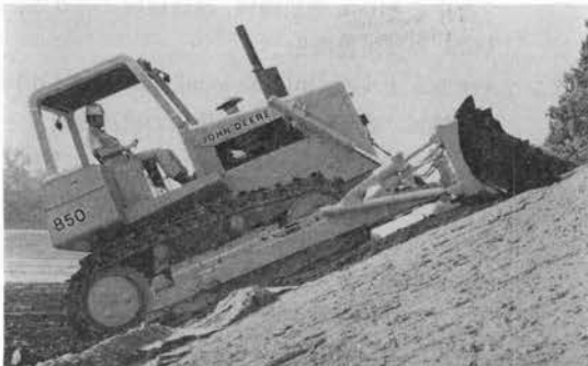
写真-1 ジョンディア 850 ハイドロスタティックドライブ・トランスミッション付ブルドーザ
