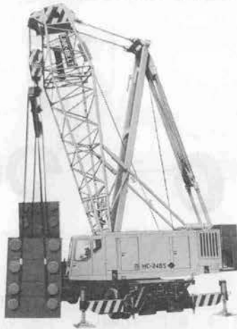
写真-7 住友 HC-248 S 機械式トラッククレーン
