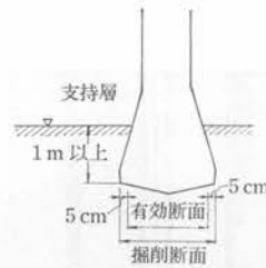
図-9 有効断面と掘削断面
