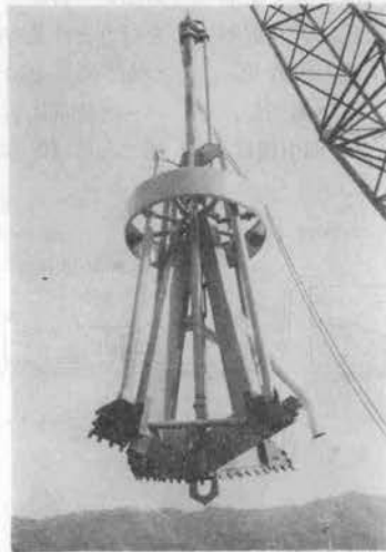
写真-3 OMR工法ビット (奥村組・丸五基礎工業)
