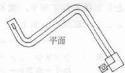
⑧ 急角度で曲がるトンネルのずり出し
