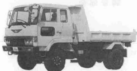
写真-5 日野“レンジャー 4W” K-FT 173 AD 全輪駆動ダンプトラック
