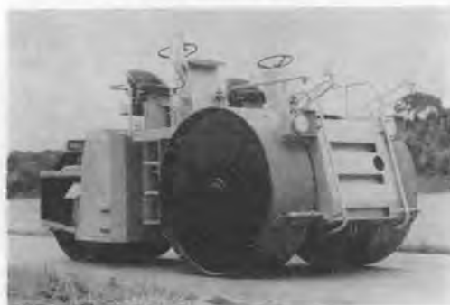
写真-9 川崎 K-10 車体屈折式マカダムローラ
