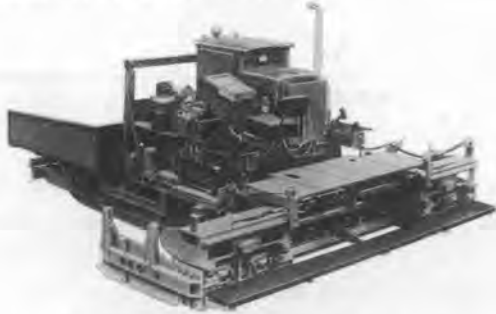
写真-11 住友 HA 45 C II 伸縮式スクリード付 アスファルトフィニッシャー
