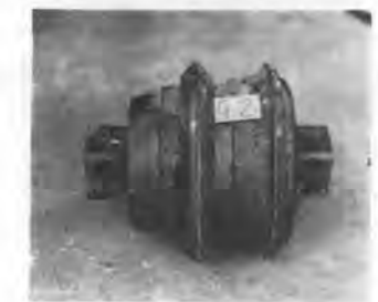
写真-4 ディスクカッタ （上は新品、下は使用済みもの）
