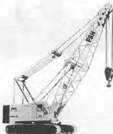
写真-7 神戸 880 S クローラクレーン
