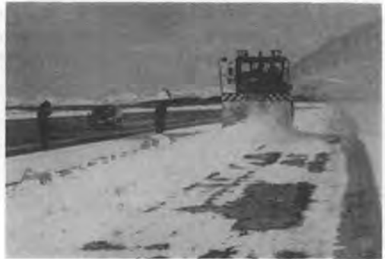
写真-2 ロータリ除雪車
