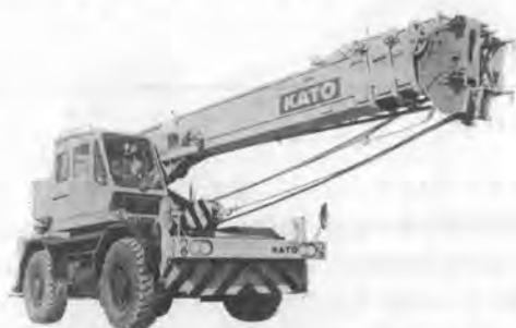
写真-4 加藤 KR-20 H ラフタークレーン
