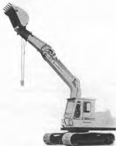
写真-1 日立UH04 s 奥山式クレーン付ショベル
