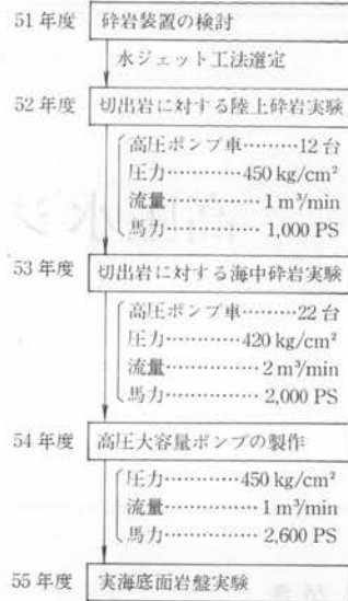
図-1 高圧水ジェット砕岩工法の開発経緯
