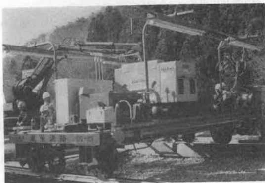
写真-35 タイングルーピングマシン前面
