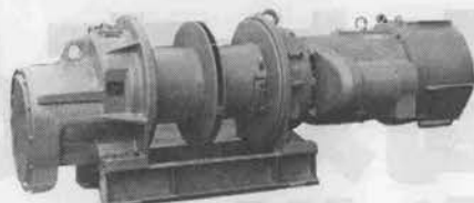
ポールチェンジ・2速度形 (低速↔高速)
