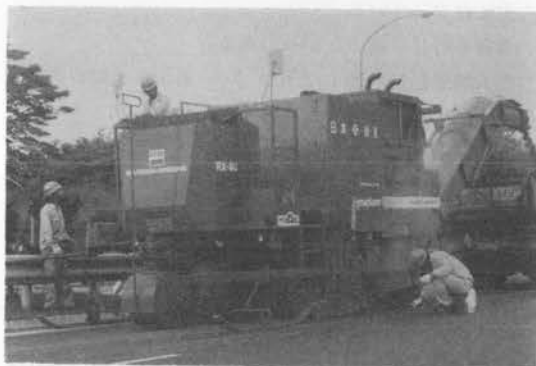
写真-38 コールドブレーナ RX-40
