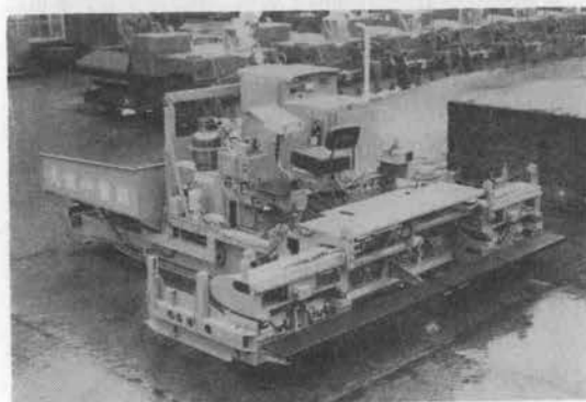
写真-34 アスファルトフィニッシャー HA 45 C-2 SW
