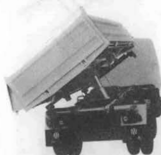
写真-4 川西 DT 10 3 転ダンプトラック
