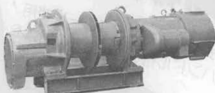
ポールチェンジ・2速度形 (低速↔高速)
