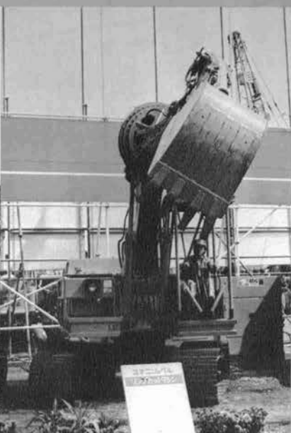
◆ 360°回転する装置をブームに付けた リングカットマシン (油谷重工)
