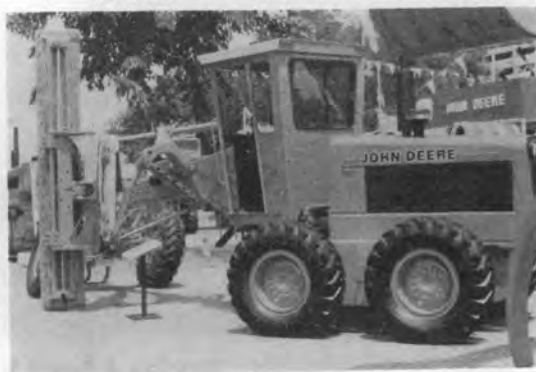
小型グレーダ (John Deere……フルスイングブレ ードおよびアーティキュレートステアリング装備)
