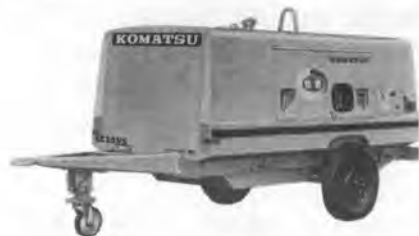
写真-9 小松 EC 35 VS-3 可搬式空気圧縮機(防音型)
