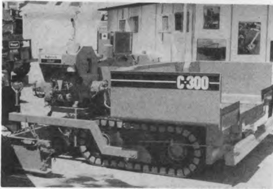
↑ 小型フィニッシャ (Babcock……タイヤを軸にしてクローラを装着し、それにゴムパットを取付けている。走行の振動を弱める目的と思われるが、ユニークなデザインである。)
