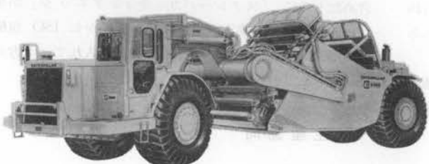
写真-2 ツインエンジンエレベータリングスクレーパ (CAT 639 D)
