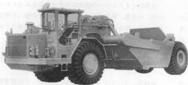
写真-1 輸出の主力スクレーパ (小松 WS 23)
