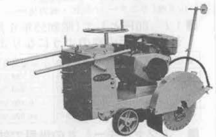
DCC-8A型 全自走式無段変速 (半自走式切換自在) 19PS 切断深30cm 重量360kg
