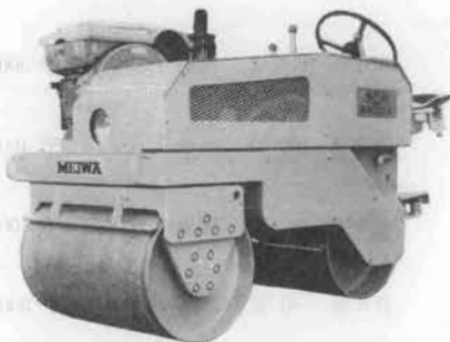
写真—2 両輪駆動・駆動振動ローラ（明和）
