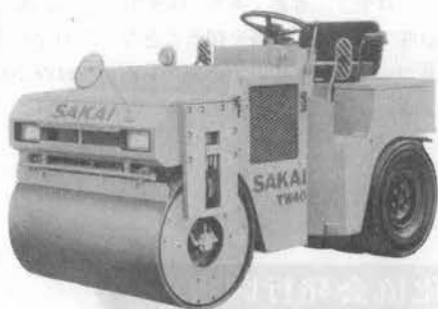
写真—1 両輪駆動・車体屈折式コンバインド型振動ローラ（酒井）
