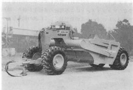
写真-4 10 m 3 軟弱地用スクレーパ (国土開発工業 10 SBW)
