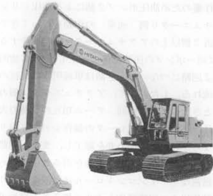
写真-1 最近の油圧ショベルのひとつロングワイドタイプ(日立UH07LC s )
