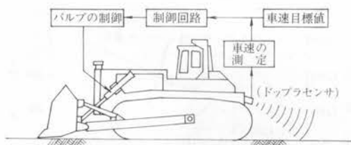
図-2 マイコンによる自動制御の概念
