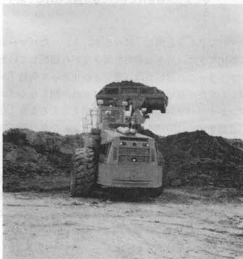
写真—2 Marathon LeTourneau 社のホイールローダ (エレクトロニック装置を広範に採用している)
