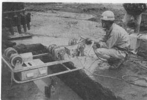
写真-3 超音波溝壁測定器
