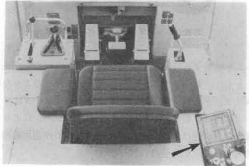
写真-9 電子式モニタリングシステム
