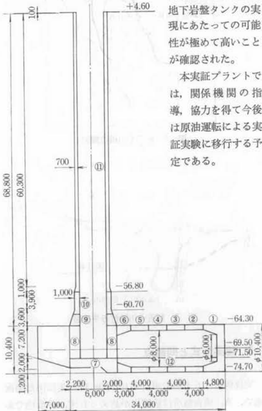
図-11 ドライポンプ室および払出配管立坑巻立コンクリート打設順序
