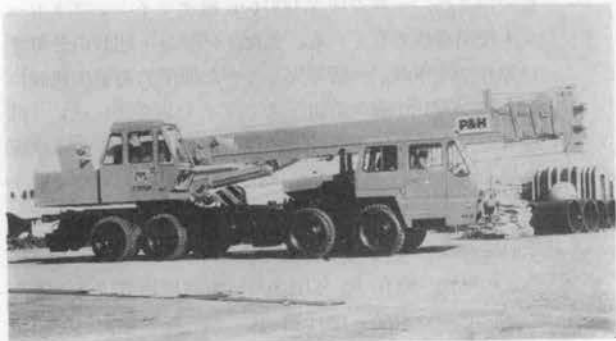
写真-5 神戸 T 250 M 油圧式トラッククレーン
