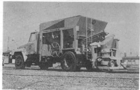
搭載車: 日野 KB1120 (8t 車) トリキサー容量: 骨材ホッパ 4.0\text{m}^3 , セメントホッパ 1.5\text{m}^3
