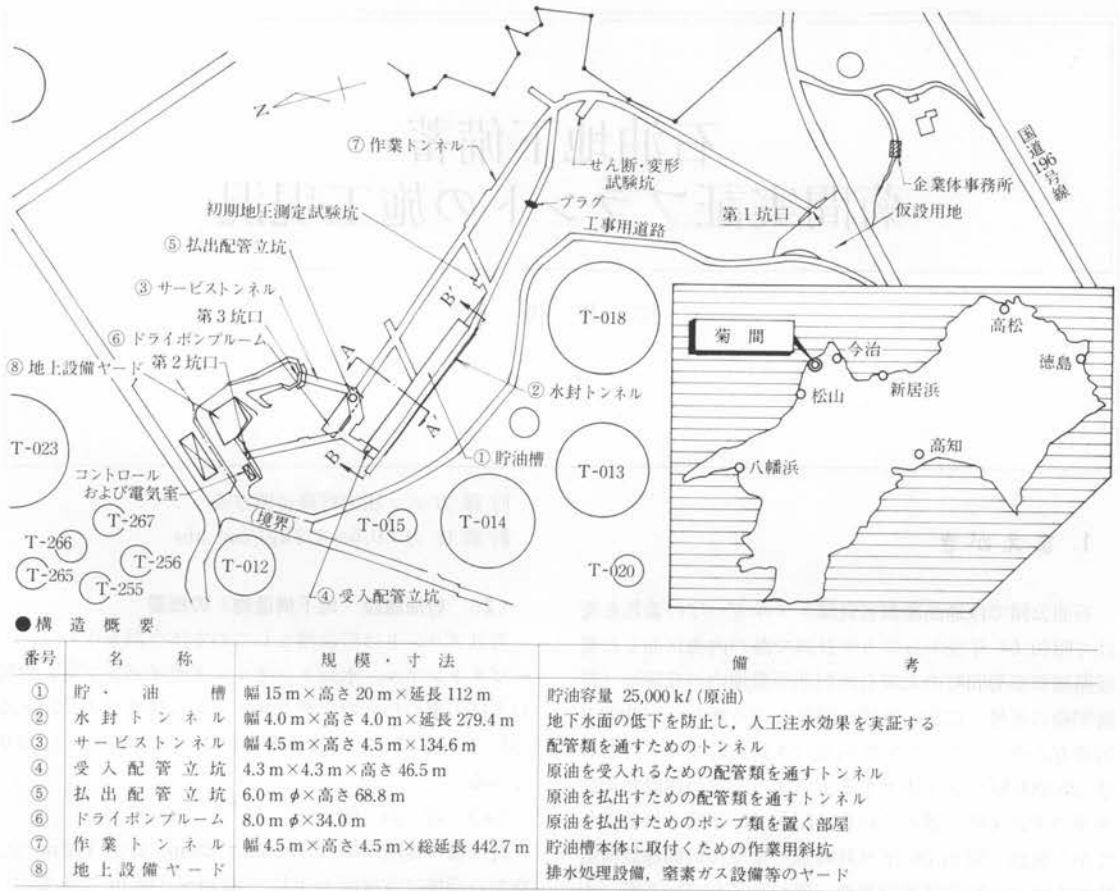
図-1(A) 菊間実証プラント計画平面図
