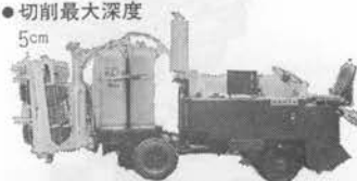
HRP-100 小形路面切削機
