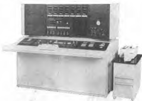
写真-11 石川島 MCS コンクリートプラント計量操作盤
