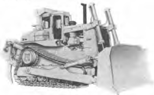
写真-1 CAT D9L ブルドーザ
