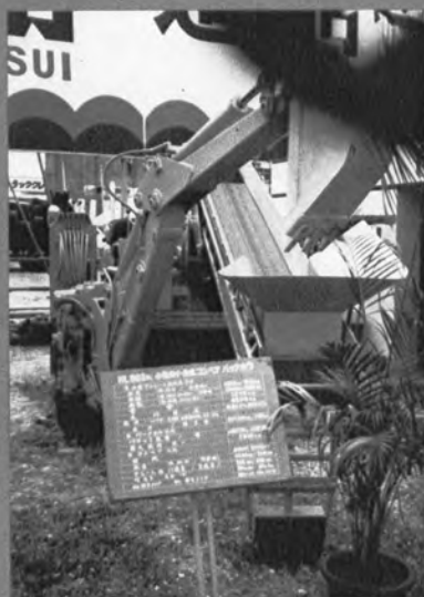
⇨ 小型ホイール式コンベヤバック ホウ HL 803 O/L (三井造船)
