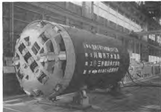
写真—3 れき泥水加圧シールド (掘削径 2.47 m)
