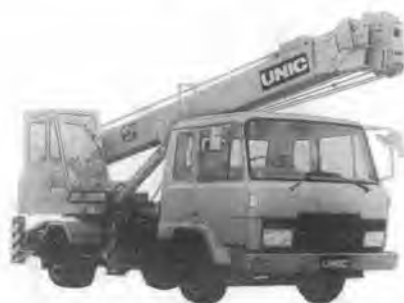
写真8 ユニック K-55 トラッククレーン
