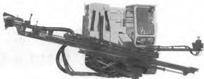
写真-1 油圧式クローラドリル のが使用されている。これらの機械もほとんどが油圧化され、作業性を高めるとともに、省力化が進められている(写真-2参照)。また機動性をより一層高めたホイール式も活躍している。
