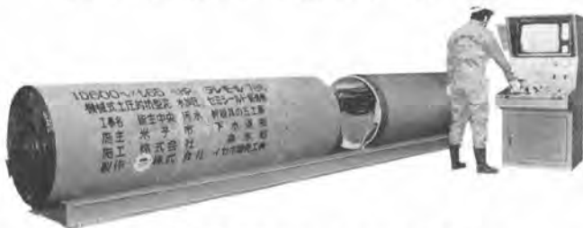
写真—2 小口径推進工法用セミシールド (掘削径 600 mm)
