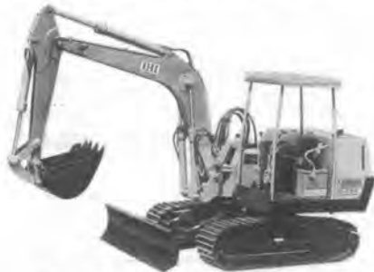
写真-1 石川島 IS-015 S ミニバックホウ
