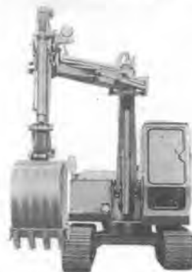
写真-3 日立 UH 025 ニュー側溝掘油圧ショベル
