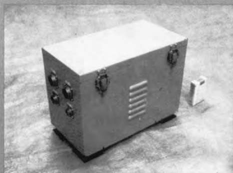
♠ ラジコン式油圧ショベルの受信機 (キャブ内に搭載)
