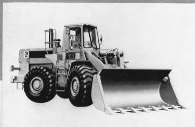
♠ ホイールローダとそれに搭載された 過積載防止装置 (バケットスケール 装置とプリントアウト装置) ♡
