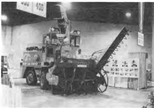
写真-2 新潟 NR 653 ロータリ除雪車
