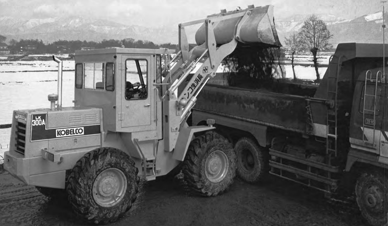
KOBELCO LK 300 A ホイールローダ 株式会社 神戸製鋼所
