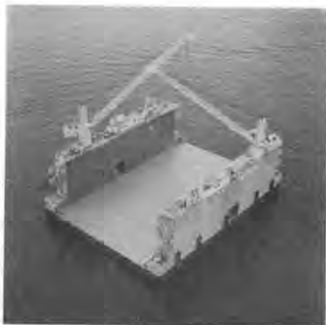
写真-4 ケーソン製作用作業台船「FD-6000-1」
