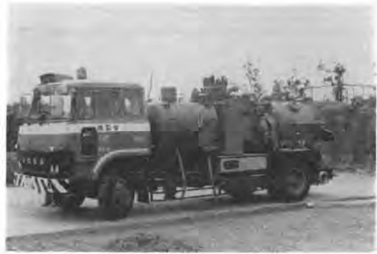
写真-5 側溝清掃車（真空吸引型、脱水装置付、建設省近畿技術）
