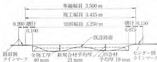
図-7 標準断面図
