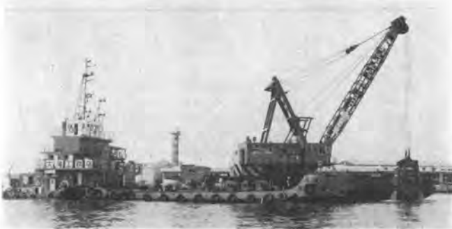
写真-2 自航式グラブ浚渫船「越後」
