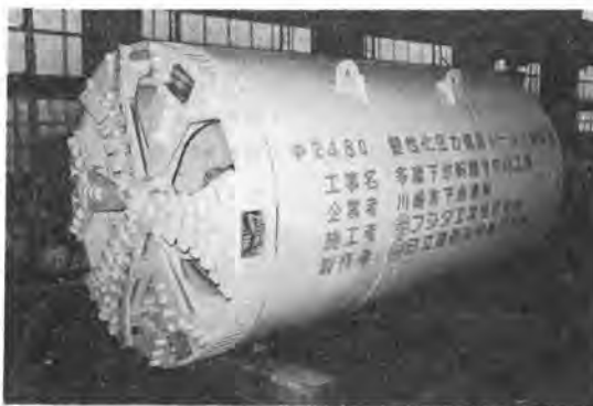
写真-7 日立造船・リボンスクリュー式泥漿シールド掘進機
