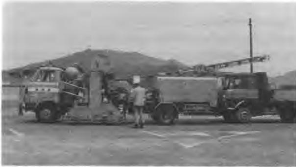
写真-1 路面整正機（常温切削型，積込装置付，建設省中国技術）
