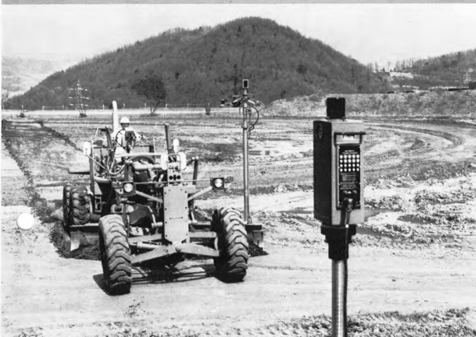
◆ 全自動レーザー式ブレードコントロール装置搭載のモータグレーダ（手前にあるのがレーザー投光器）
