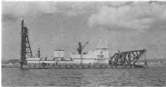
写真-1 7,000 PS ボンプ浚渫船「第三亜細亜丸」
