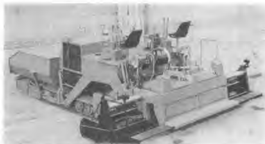
写真-3 伸縮自在スクリード(前後のスクリードを左右にスライドさせるもの)
