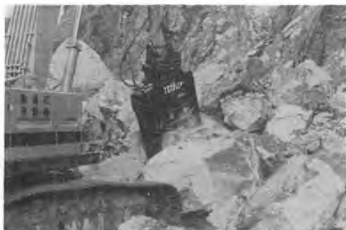
写真-9 三五重機 TS 1500 RS 石割り用クラッシャ
