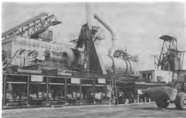
写真-1 60 t/hr 再生アスファルトプラント
