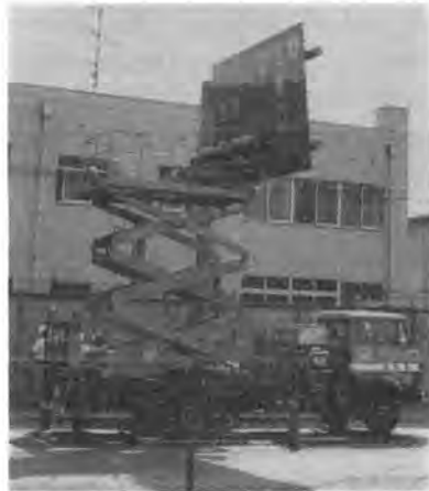
写真-6 標識清掃車（垂直昇降式、建設省関東技術）
