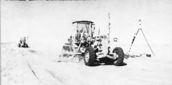
◆ 中近東で農場整備中の全自動レーザー式ブレードコントロール装置搭載のモータグレーダ
