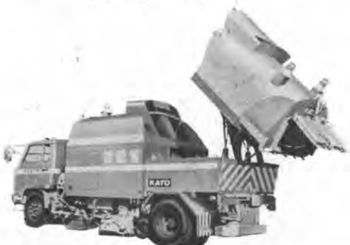
写真-4 路面清掃車（リフトダンプ型真空式、加藤製作 HS-60 L）
