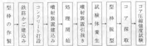
OPA 工法 図-2 実験フロー
