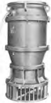
写真-5 軸流型水中ポンプ (桜川 G-2030 型) 呼び径: 500 mm 全揚程: 3 m 吐出量: 30 m 3 /min 電動機出力: 22 kW 重量: 980 kg
