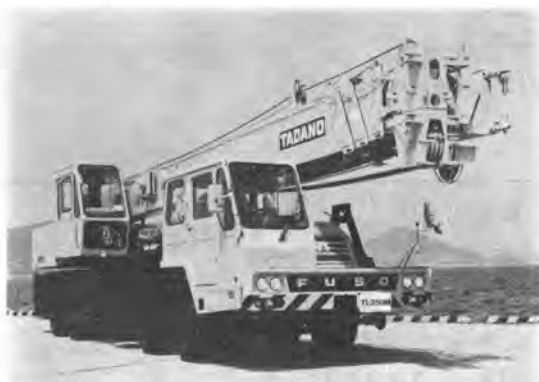
写真-8 多田野 TL-250 M 油圧式トラッククレーン
