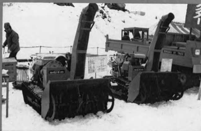
⇨ フジ FSR-1100 GKD (20 PS) と FSR-1100 SH (15 PS) 小型ロータ リ除雪機
