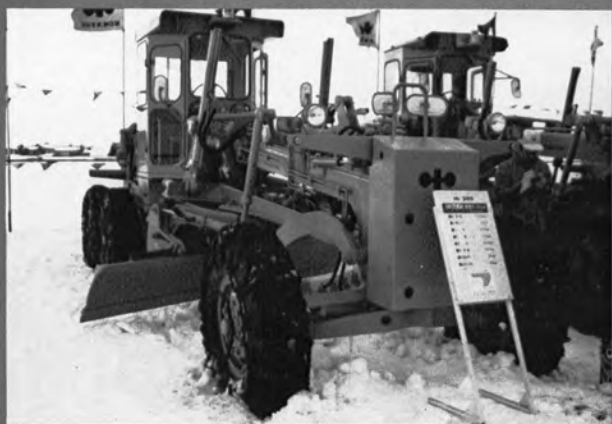
◆小松 GD 705 R 除雪グレーダ (ブレード幅 4 m, 230 PS)
