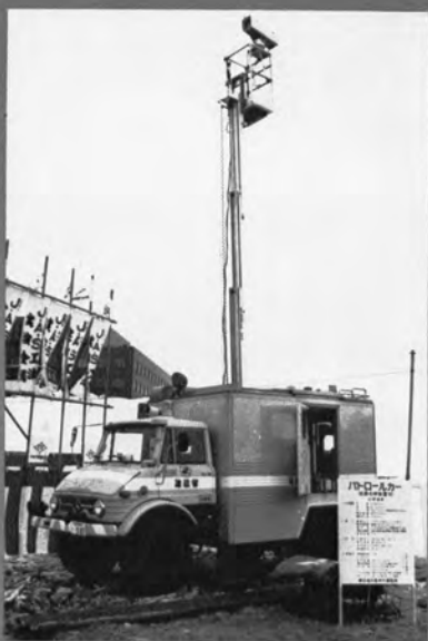
◆のり面点検装置付パトロールカー (建設省北陸地建)
