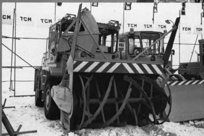
東洋運搬機 R350 ツーステージ型 ロータリ除雪車 (出力 360 PS, 能力 2,500 t/hr)
