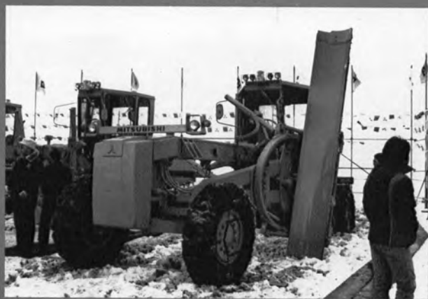
◆キャタピラー三菱 MG 500 除雪グレーダ (ブレード幅 4 m, 175 PS)
