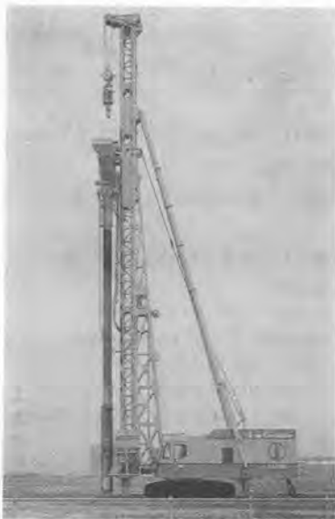
写真-4 陸上施工機 (Acom Consolider)
