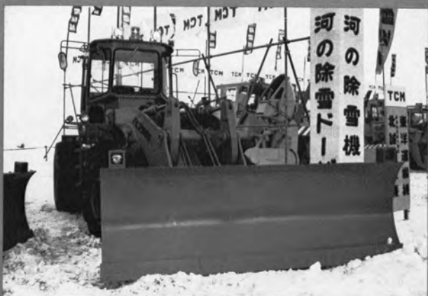
◆古河 FL200 B アングリングブラウ付 除雪ドーザ (155 PS, 13.95 t)
