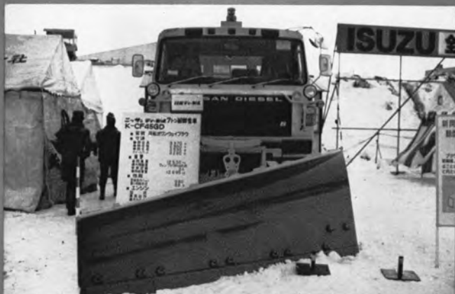
⇨日産ディーゼル K-CF 45 GD 反転式アングリングブラウ付 除雪トラック (275 PS, 4×4)
