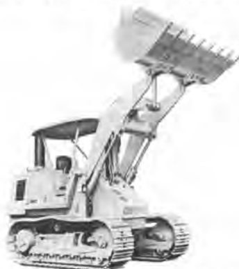
写真-3 H.S.T 駆動の CAT 953 トラクタショベル
