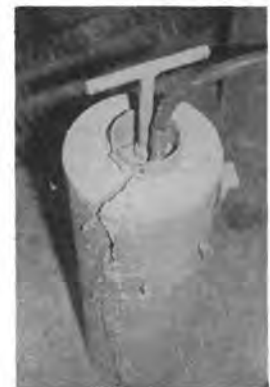
写真-7 油圧ジャッキによる破砕
