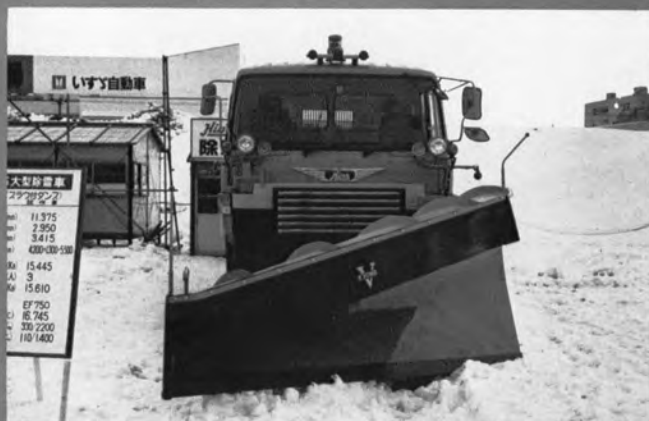
日野 EF 750 ワンウェイブラウ付 除雪トラック (330 PS, 6×6) ⇨
