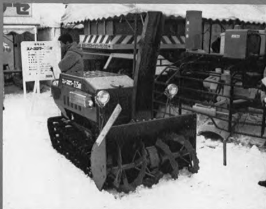
⇨ ヤナセ IZ-Y 11-25 HD ハンドガイド式 小型ロータリ除雪機 (25.5 PS)
