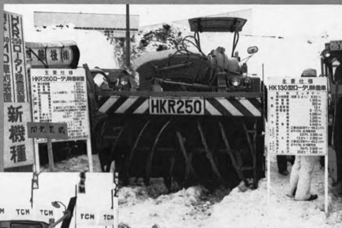
開発農機 HKR 250 ツーステージ ユニット型ロータリ除雪車 (出力 130 PS, 能力 800 t/hr)
