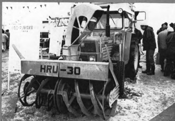
農業用トラクタ装着型小型ロータリ除雪装置 (建設省北陸地建, 32 PS) ⇨
