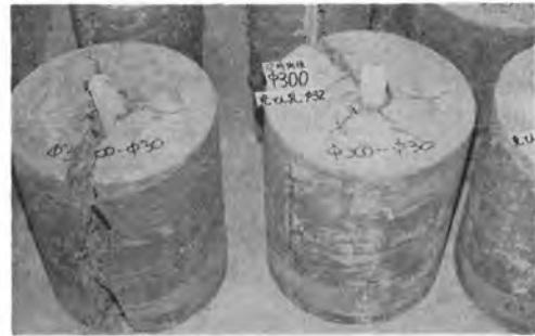
写真-5 静的破砕剤による破砕
