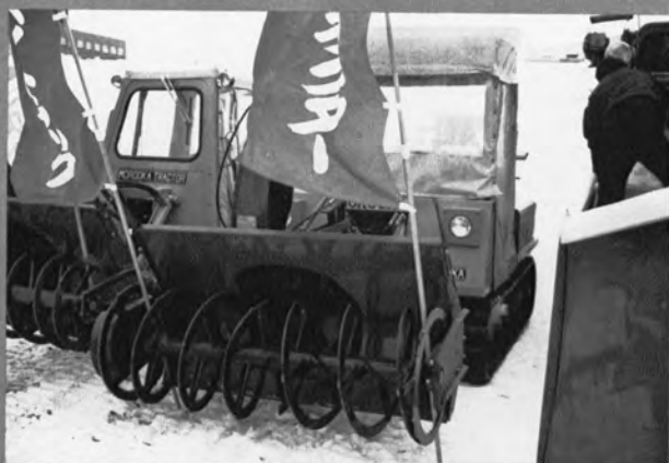
諸岡 P・P 5000 搭乗式ロータリ除雪装置付 トラクタ (出力 62 PS) ⇨
