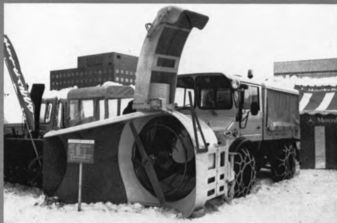
ウニモグ・シュミット GS-3 ワンステージ型ロータリ除雪車 (作業用出力 295 PS, 能力 3,300 t/hr)
