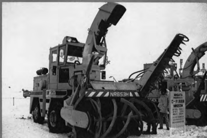
新潟 NR 653 H 高雪堤処理用 スイングオーガ付ロータリ除雪車 (出力 260 PS, 能力 1,700 t/hr)
