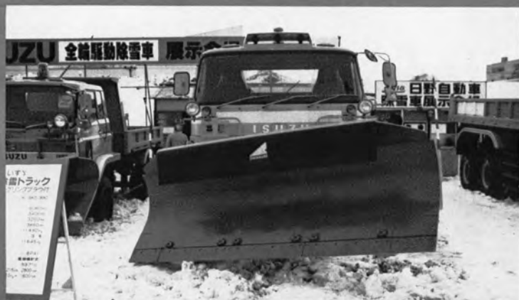
⇨いすゞ SKS 390 アングリング ブラウ付除雪トラック (215 PS, 4×4)
