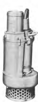
写真-3 工事一般排水用水中ポンプ (ツルミ KRS 型) 呼び径: 200 mm 全揚程: 18 m 吐出量: 4.0 m 3 /min 電動機出力: 22 kW 重量: 390 kg
