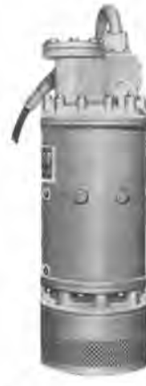
写真-4 超高揚程工用水中ポンプ (桜川 U-22006 型) 呼び径: 150 mm 全揚程: 200 m 吐出量: 2.5 m 3 /min 電動機出力: 150 kW 重量: 1,250 kg
