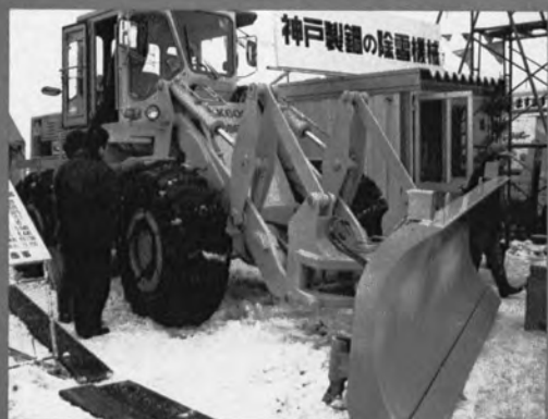
◆神戸製鋼 LK 600 アングリングブラウ付 除雪ドーザ (155 PS, 13.7 t)
