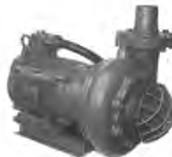
写真-6 濃泥用横型工用水中サンドポンプ (三興 SDK-430) 呼び径: 100 mm 全揚程: 25 m 吐出量: 1.0 m 3 /min 電動機出力: 22 kW 重量: 350 kg
