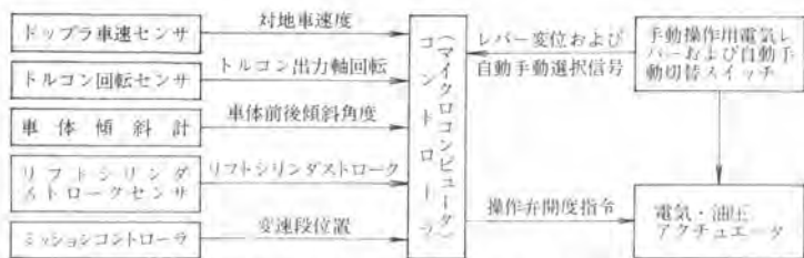
図-3 マイコンを搭載した小松 D 555 ブルドーザの制御システム
