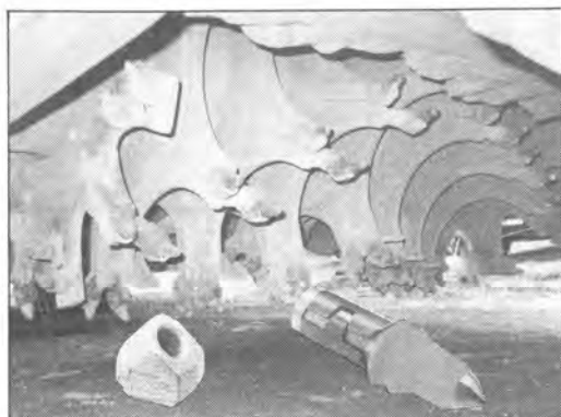
切削及びスタビ共用 ビット取付プレート (実用新案出願中)
