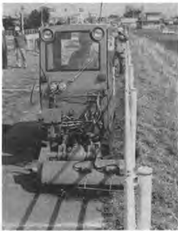
写真-5 路肩土砂処理機
