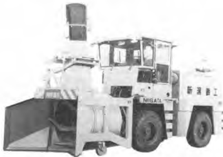
写真-10 新潟 NR 811 高速ロータリ除雪車
