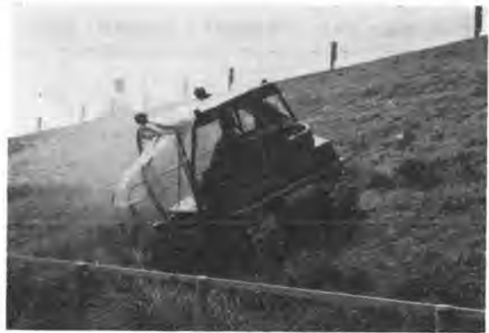
写真-2 斜面草刈機（後部）
