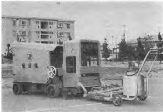
写真-2 小型路面整正機
