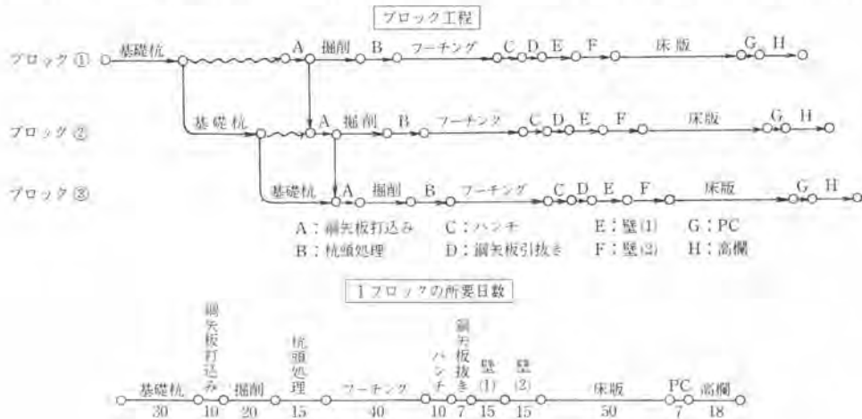
図-4 1 ブロックの所要日数および工程
