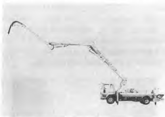
写真-9 IHI IPF-85 B コンクリートポンプ車
