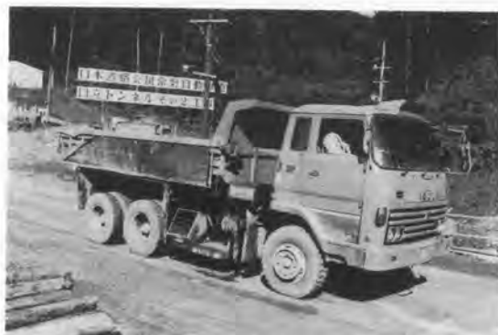
写真-5 排気ガス除去装置付ダンプトラック
