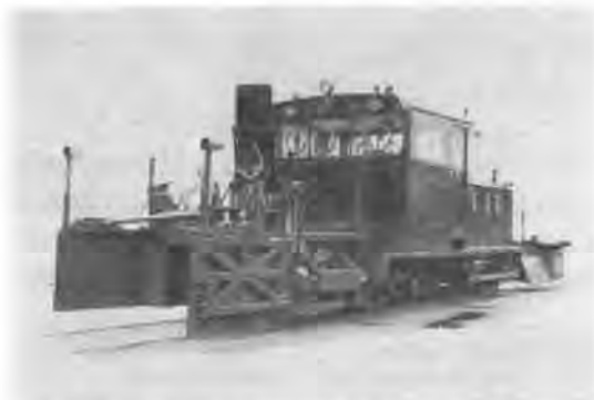
写真-2 軌道モータカー (新幹線用ロータリ装置付)
