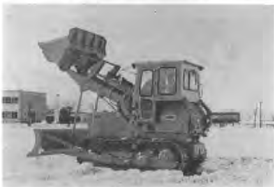
写真-4 騒音対策型ブルドーザ
