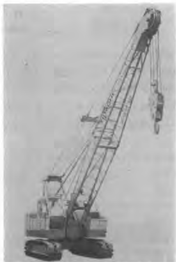
写真-6 日立 KH 75 油圧式クローラクレーン
