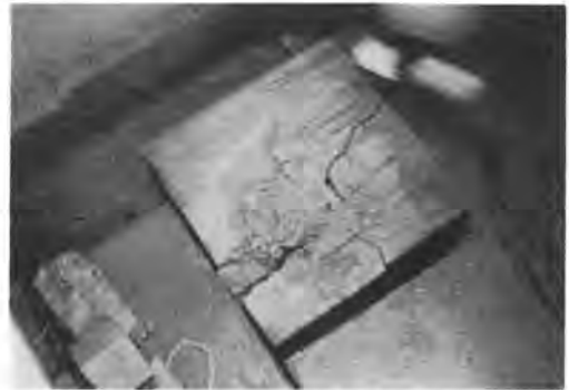
写真二 海水中におけるモルタルブロックの破砕例 (60 kW × 20 min)
