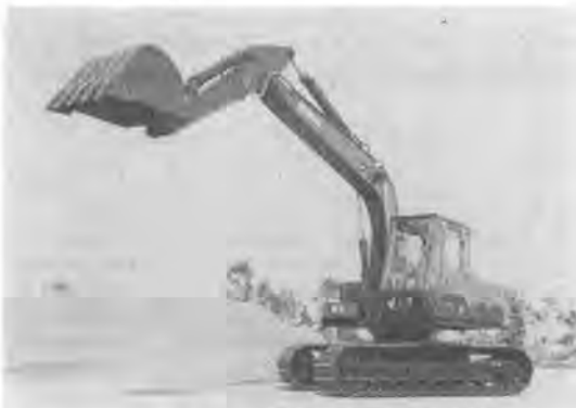
写真-4 神戸 K 904 CL 油圧ショベル
