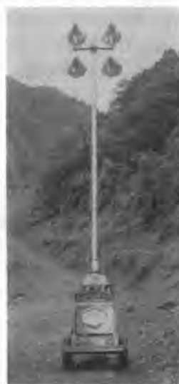
写真-40 現場内移動局部照明装置
