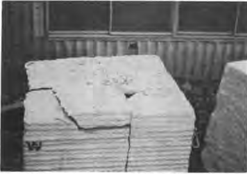
写真一 花崗岩試料の破砕例 (50 kW × 86 min)
