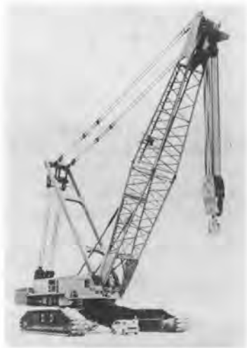
写真-7 神戸 5650 クローラクレーン
