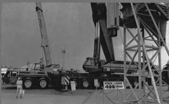
⇨ GOTTWALD 400 t トラッククレーン
