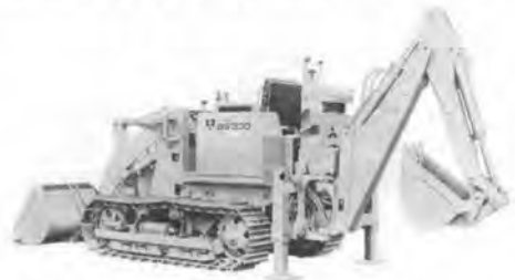
写真-6 三菱 BS 300 B バックホウ付トラクタショベル
