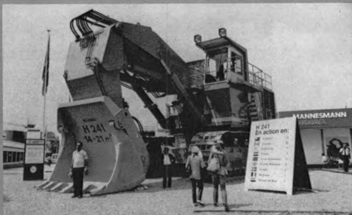
DEMAG H 241 油圧ショベル (270 t, 1,318 HP)
