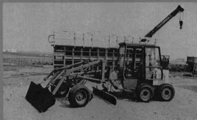
⇨ 各種アタッチメントをもつ 小型グレーダ BLADE MOR 727 (エンジンはいすゞ製)
