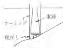
図-7 傾斜岩盤掘削法
