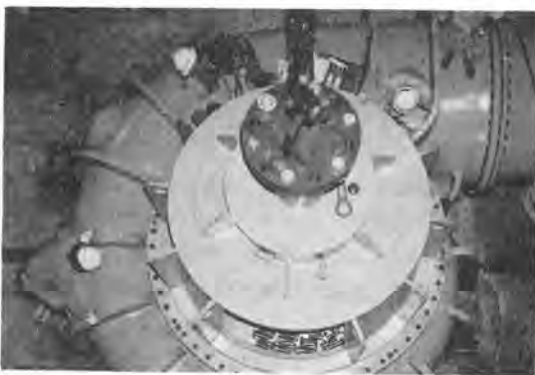
写真-4 10 m³/sec 揚排水兼用ポンプの工場仮組立
