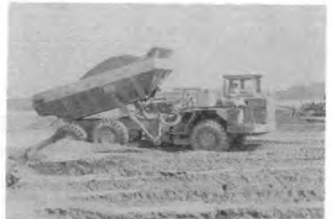
写真-2 アーティキュレートダンプトラック (小松 HA 360) の排土状況
