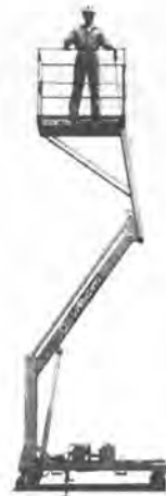
シグマΣリフト 電動式簡易高所作業車
