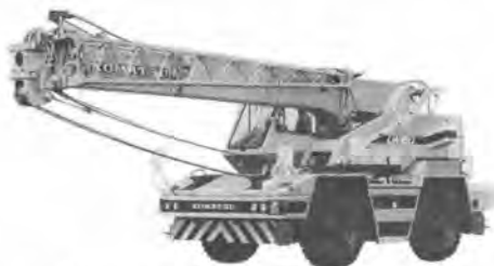
写真-7 小松 LW 160 ラフテレンクレーン
