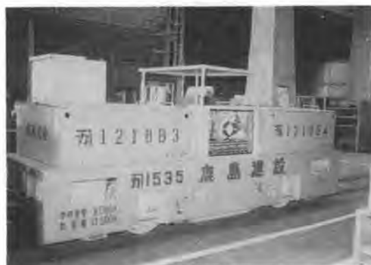
写真-1 バッテリーロコの外観
