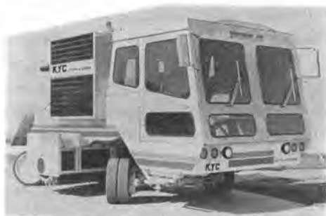
写真-12 光洋 DYP-4300 Z ダイナミック・プレーナ
