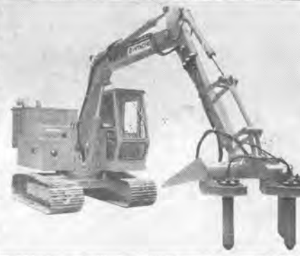
バイブドーザー(ダム用機械打バイブレーター)
