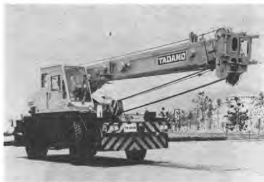
写真-6 多田野 TR-160 M ラフターラインクレーン
