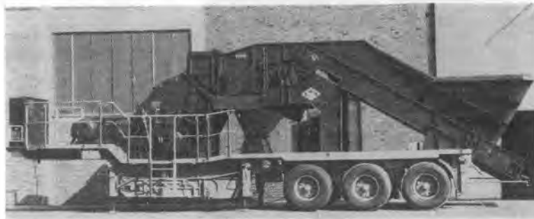
写真-1 移動式破砕装置
