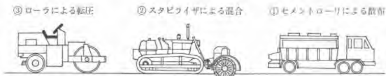
図-2 直接混合方式による地盤改良
