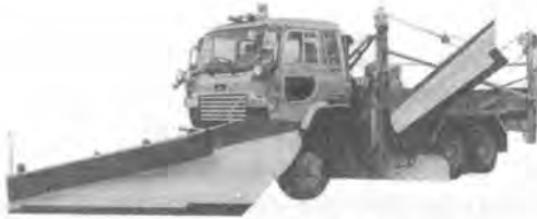
写真-14 日野 K-FU 633 全輪駆動 大型トラック (除雪仕様)
