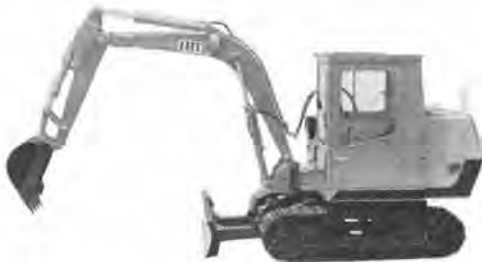
写真-1 石川島 IS-40 S ミニバックホウ
