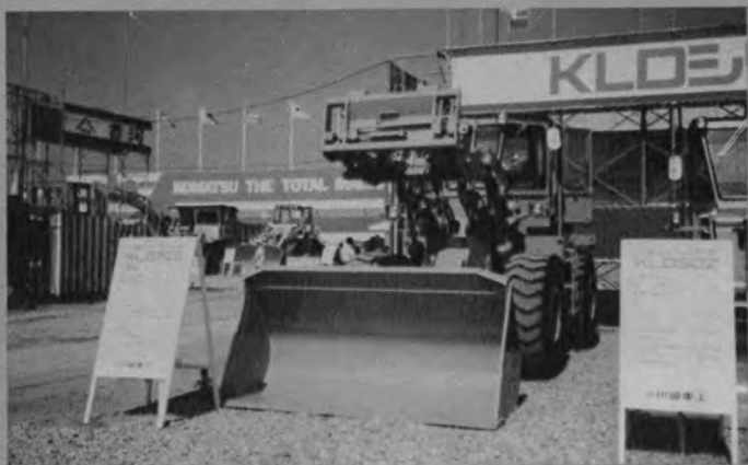
⇨ バケット着脱が簡単に行えるクイック カブラ付ショベルローダ KLD 70 II (2.5m 3 , 川崎重工業)
