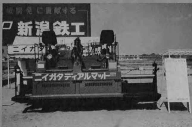
舗装幅を油圧で2.5~4.5mと任意に 変えられるアスファルトフィニッシャー NF 220 VDM (新潟鉄工所) ⇨
