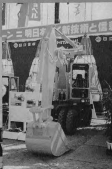
⇨ 隙間で溝掘りができるブームス インク式油圧ショベル WH 04 D (0.5m 3 , 日立建機)
