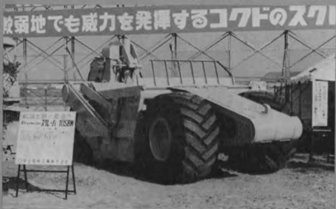
軟弱地用超ワイドタイヤ装着の 被けん引式スクレーパー 10 SBW (9.1m 3 積, 国土開発工業)
