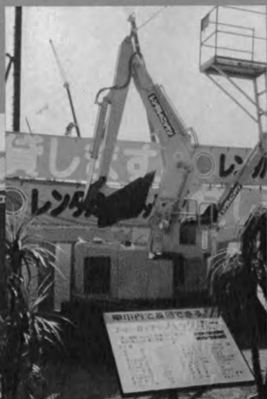
⇨ 車幅内で旋回できるコーヒーカー ップ式バックホウ CCBH 21 II (0.25m 3 , レンタルのニッケン)
