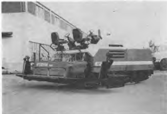
写真-10 新潟 NF 330 V-DM アスファルトフィニッシャー
