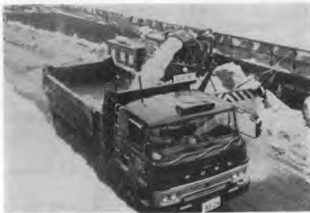
写真—1 ロータリ除雪車によるダンプトラックへの雪の積込み
