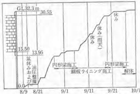
図-3 スリップフォーム工事施工実績(昼間のみ作業)
