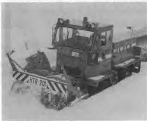
写真-1 ロータリ除雪車
