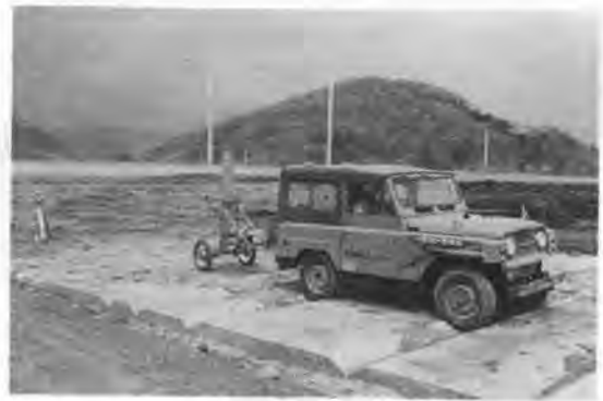
写真-1 悪路試験場とプロフィロメータ
