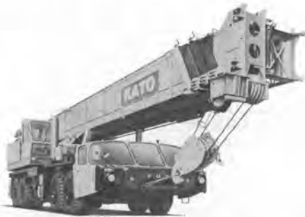
写真-7 加藤 NK-1200-II 油圧式トラッククレーン
