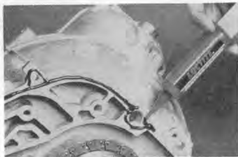
カットガスケットに代って使用されるようになった粘着剤
