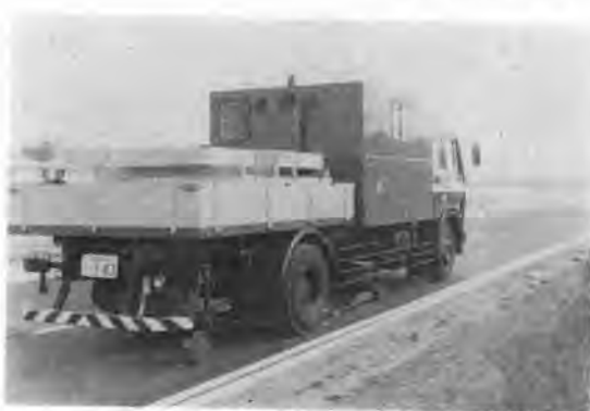
写真-2 自走式路面たわみ測定車(後)
