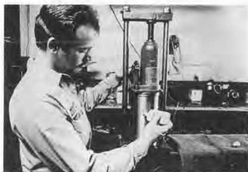
プレスばめの保持力はシール剤の使用によって増大する
