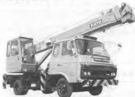
写真-6 加藤 NK-70-II トラッククレーン
