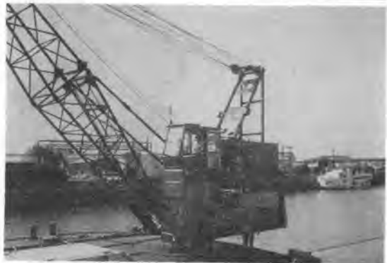
写真-8 日立 UH 30 バックホウ・クレーン兼用船
