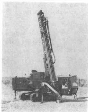
写真-10 古河 HRD-2000 全油圧式ロータリドリル
