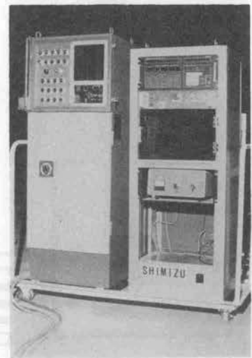
写真一 ロボット制御盤
