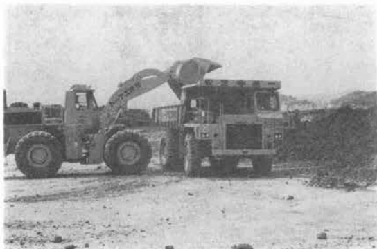
写真-7 988Bホイールローダによる769C ダンプトラックへの積込作業
