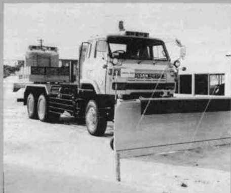
◇アンダリングブラウ付除雪トラック (6×6) K-CZ 50 M (日産ディー ゼル)
