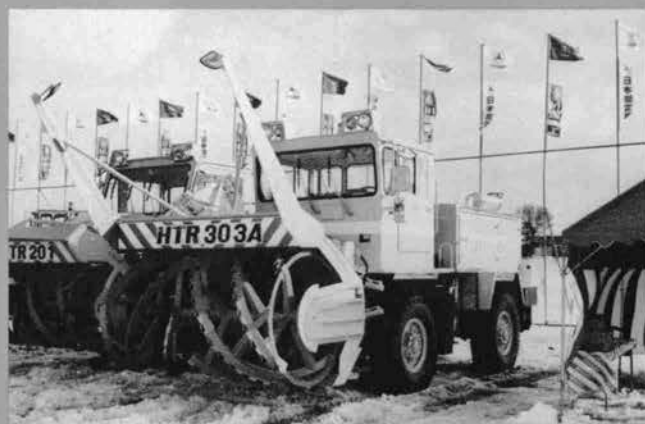
大型ロータリ除雪車 HTR 303 A (日本除雪機)。オーガに放置チェーンを捨てるフックが取り付けられ、まき込み防止を図った。
