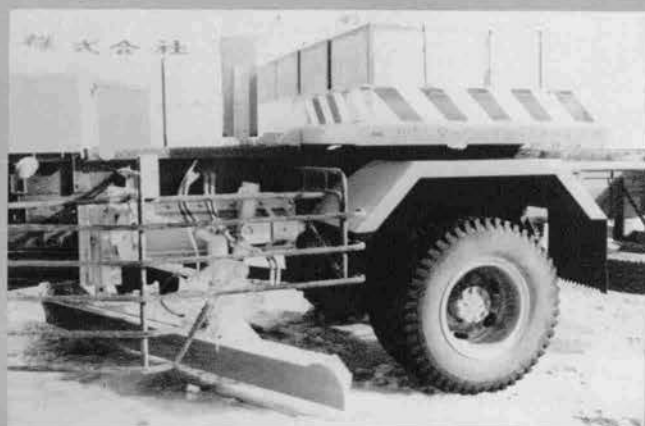
◇カウンタウエイトスライド式トラックグ レーダ (岩崎工業)。作業/回送によってカウ ンタウエイトを移動させバランスをとる。
