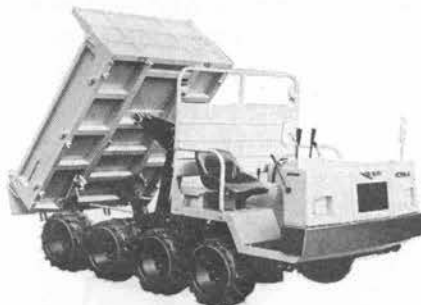
写真-8 北越 HC 18 W-M ダンプキャリア
