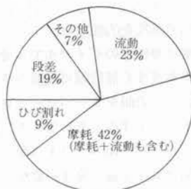
図-4 路上再生処理工法既設路面の性状別分類 (55.6~58.2)
