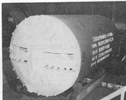
写真-10 日立建機クラッシャ付泥水加压 シールド掘進機
