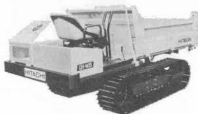
写真—6 日立 CH-M 15-2 クローラキャリア
