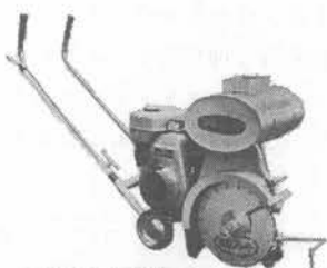
DCC-OR型 転量型4PS 切断深10cm 重量38kg
