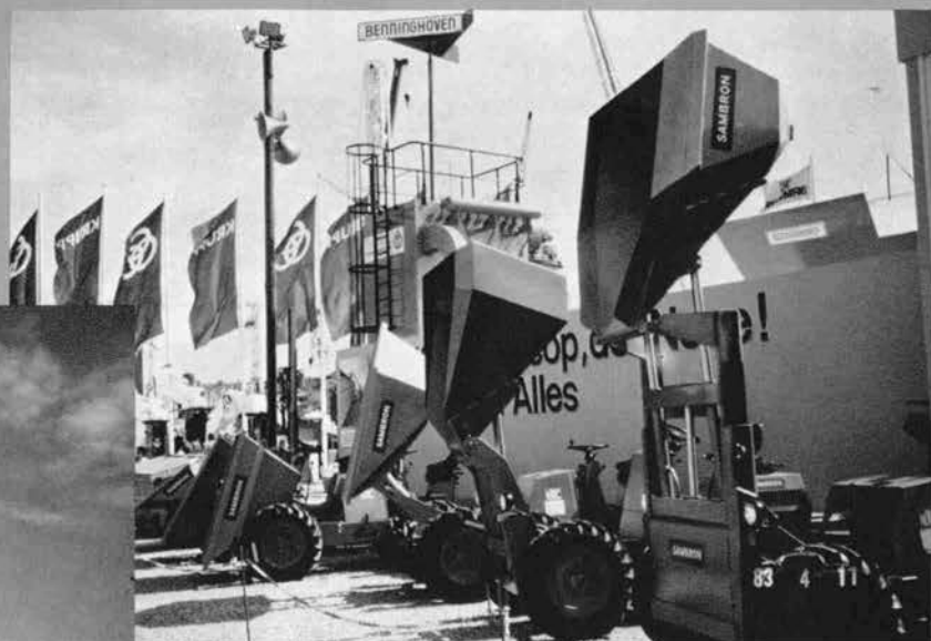
⇨コンクリート運搬車
