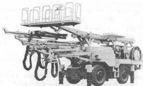
写真-7 東洋工業 THMJ-2350 AD さく孔ロボット
