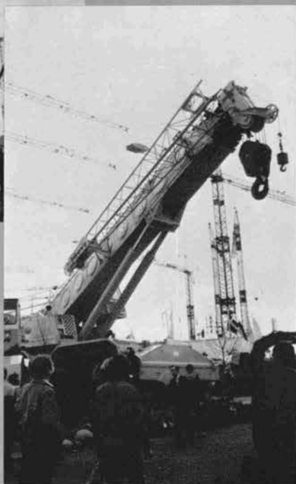
◆150tブリラフタークレーン
