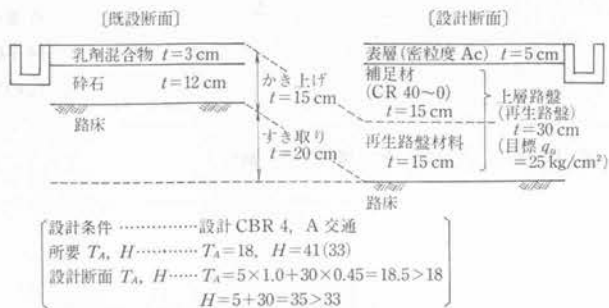
図-9 一般県道里見～南中郷(T)線断面図
