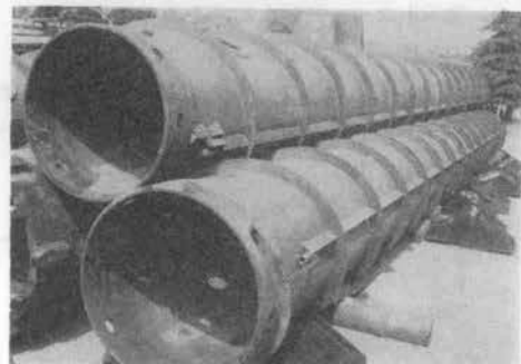
写真-6 スパイラルケーシング
