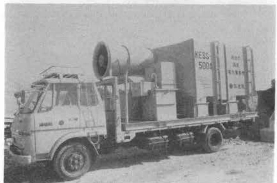
写真-31 電気集塵機
