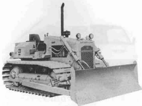
写真-1 CAT D4E ブルドーザ
