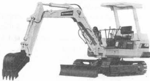
写真-1 小松 PC 30-3 ミニバックホウ
