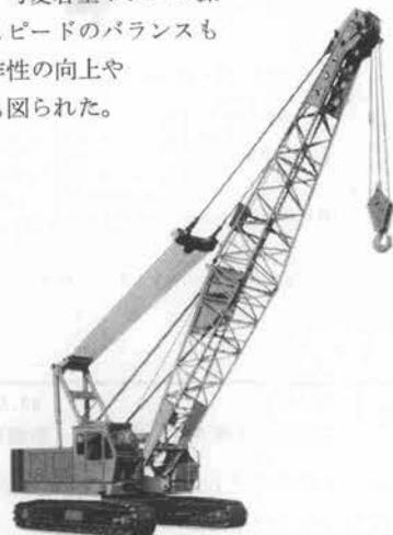
写真-10 石川島 CCH 500 クローラクレーン
