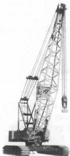
←写真-9 日立 KH 1000 油圧式クローラクレーン
