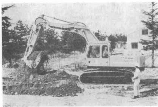
写真-4 小松 PC 200 R 無線操縦式油圧ショベル
