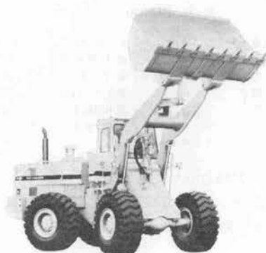
写真-5 小松 540 B 車輪式トラクタショベル
