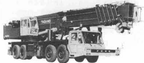
写真-8 多田野 TG-1200 M 油圧式トラッククレーン
