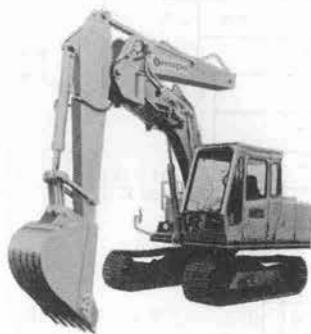
写真-2 日立 UH 035 側溝掘り油圧ショベル
