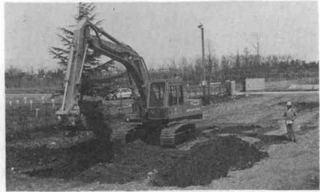
写真一 無線遠隔操縦式油圧ショベル
