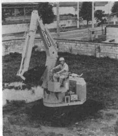
写真-1 レンタルのニッケン CBH-21-II コーヒーカップ式バックホウ
