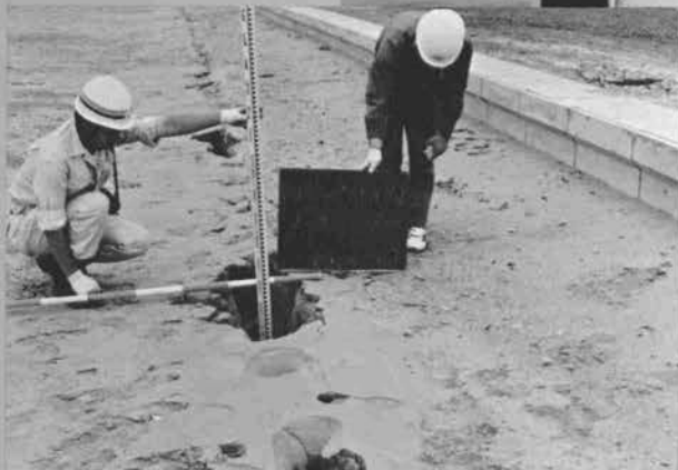
上部工が全長にわたり陸側に傾斜し、 クラックが発生 (向浜 2 号岸壁) ⊕
