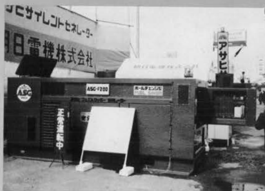
㊦ポールチェンジ型発電機 (朝日電機)
