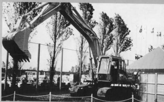
◆ラジコン式油圧ショベル (建設省北陸地方建設局)
