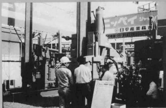
◇鋼矢板圧入引抜機 NMP 200 (日平産業)
