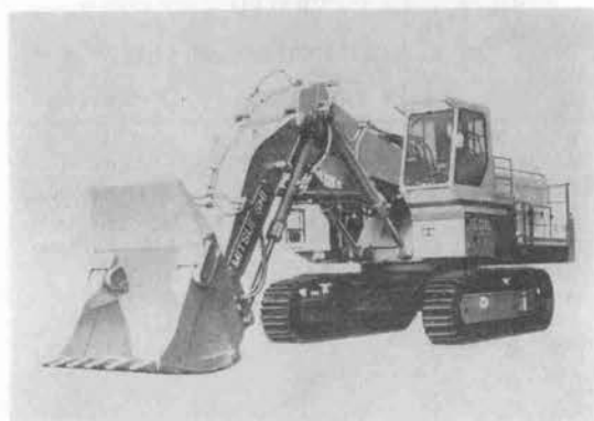
写真-4 三菱 MS 1600 油圧式パワーショベル
