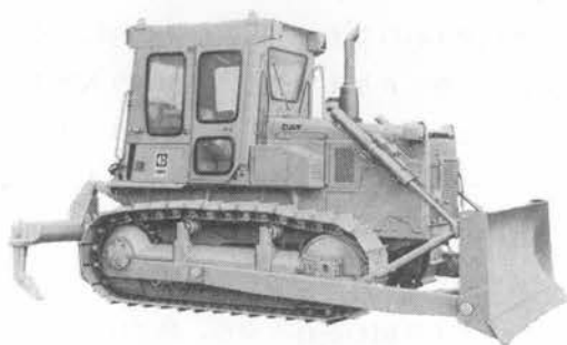
写真-1 D6D 耐寒仕様ブルドーザ
