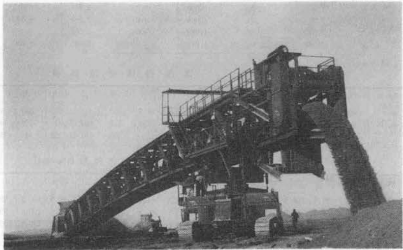
写真-2 → ベルトローダ部分
