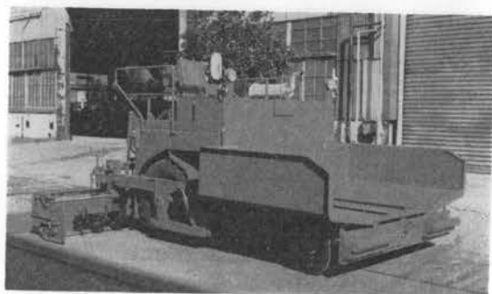
写真-13 東京工機 MT-FW 4 H アスファルト フィニッシャー
