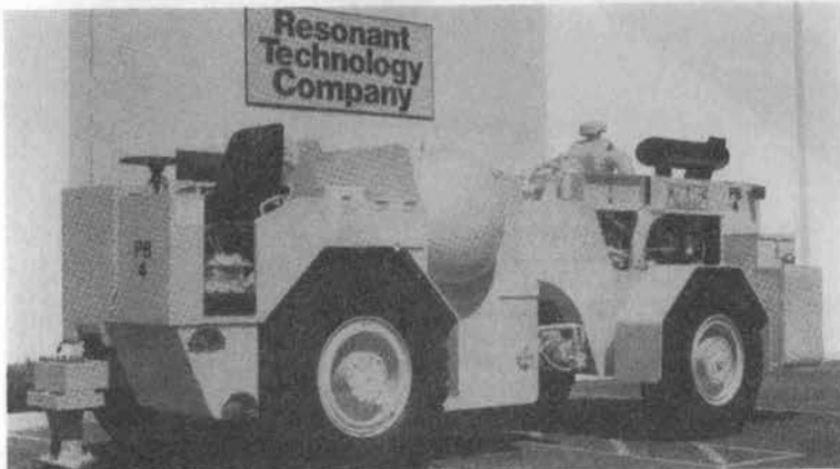
写真-1 低騒音・高能率コンクリート舗装版破碎機 PB4
