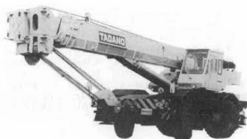
写真10 多田野 TR-400 E ラフターラインクレーン
