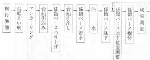
図-10 係留ベース据付フロー
