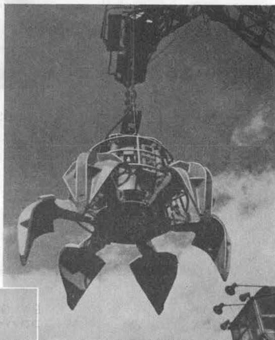
電動油圧式ポリップ型バケット
