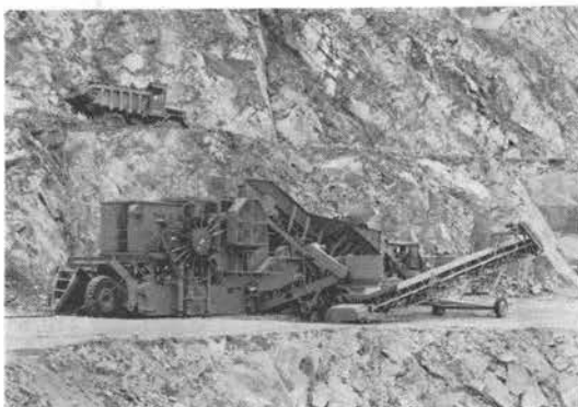
写真11 栗本 WJ-II S モービルスキッドクラッシングユニット
