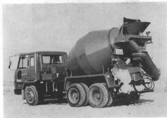
写真-12 新明和 KCP 200 F コンクリートポンプ付ダイレクトミキサ
