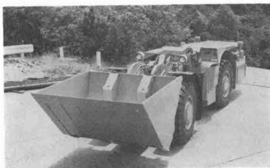
写真-6 川崎 KLD-M8 ロードホールドランブ
