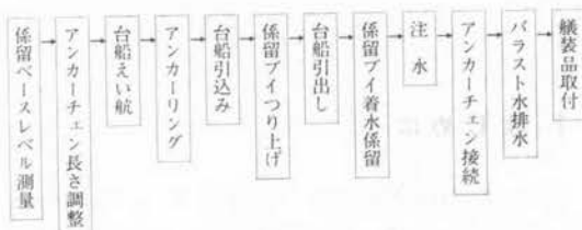
図-12 係留ブイ取付フロー
