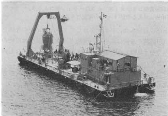
写真-3 サービスカプセルと揚収支援船
