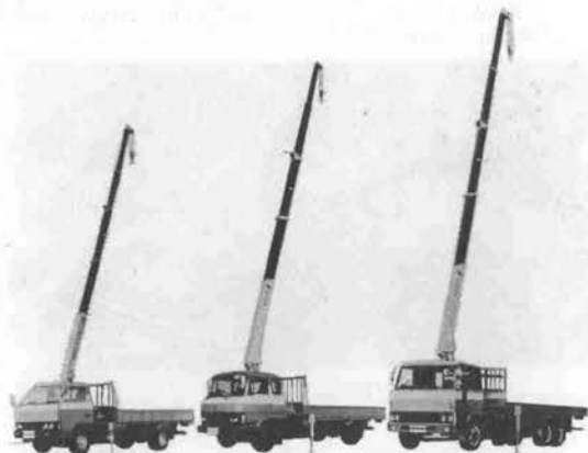
写真-7 多田野 TM-20 ZHHM, TM-30 ZHHM, TM-45 ZHHM ミニクレーン
