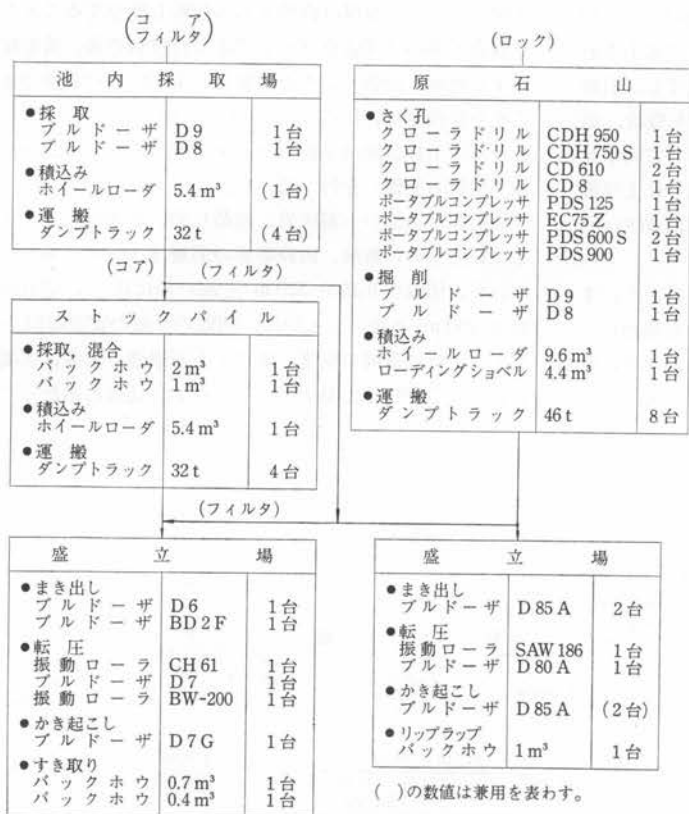
図-4 土用ダム盛立施工機械標準配置
