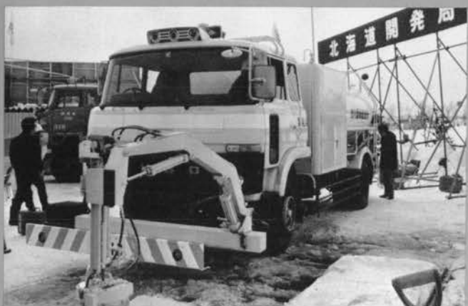
④ 氷盤溝切装置 (高圧水 330 kg/cm 2 ) (北海道開発局協賛出品)
