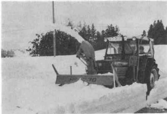
写真-1 農業用トラクタをベースとした ロータリ除雪車（実用機）
