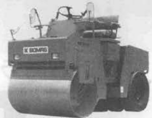
BW121AC (コンバインド) 重量 3,550kg 起振力 2.2t 転圧巾 1,200mm
