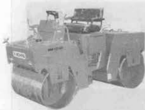
BW121AD 重量 4,000kg 起振力 4.4t 転圧巾 1,200mm
