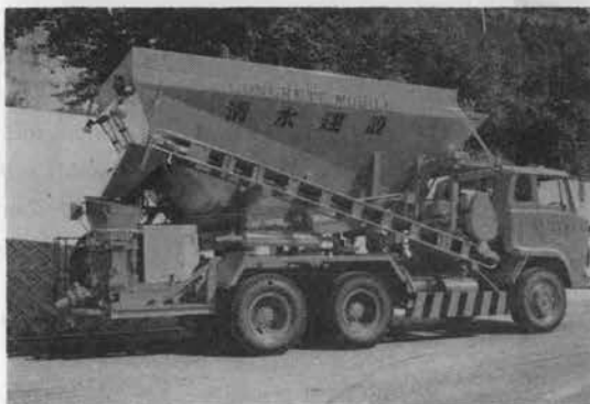
写真-1(B) コンクリートモービル(ドライ側)
