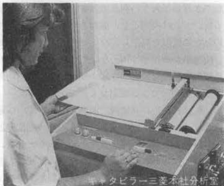
写真三 オイルの劣化度を測定する赤外線分光光度計
