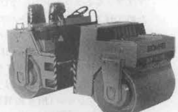
BW141AD (BW140AD) 重量 6,180kg 起振力 10.2t 転圧巾 1,420mm
