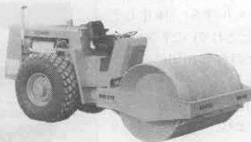
BW212 (BW210) 重量 8,880kg 起振力 16.9t 転圧巾 2,100mm
