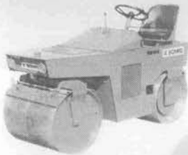
BW90A 重量 2,500kg 起振力 2.5t 転圧巾 900mm
