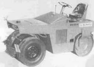
BW102AC (コンバインド) 重量 2,500kg 起振力 2.5t 転圧巾 1,000mm
