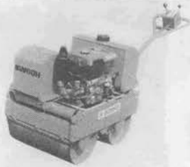
BW60HD 重量 600kg 起振力 1.4t 転圧巾 600mm
