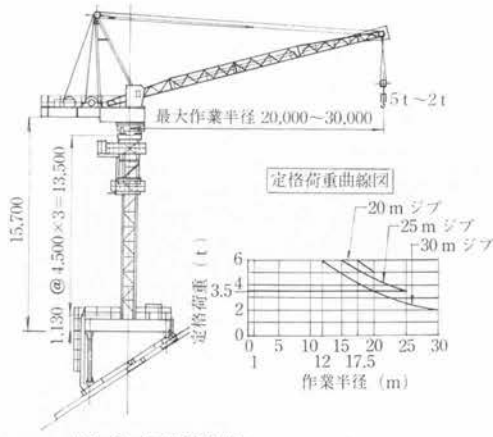
図-6 傾斜移動式クライミングクレーン
