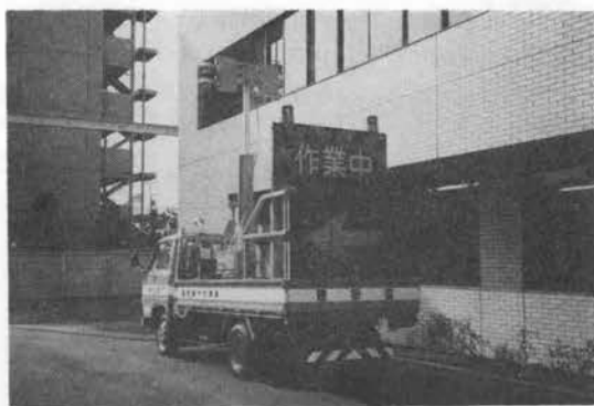
写真-5 照明装置付標識車
