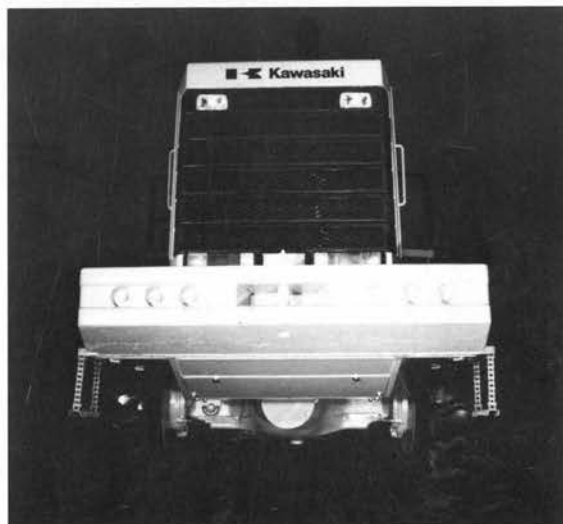
●バケット容量3.5m 3 、エンジン出力243ps。新開発のデュアルミッションを搭載し、デザインも一新したニューモデル・KLD88Z II。
