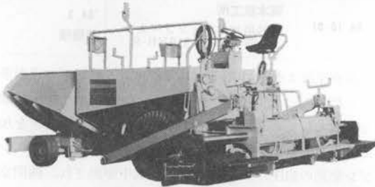
写真-12 新潟 NFW 130 V-SMR アスファルトフィニッシャー
