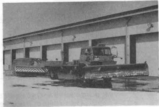
写真-4 スノープラウにけん引された被けん引式スノースイーパー
