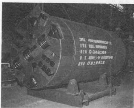
写真-32 玉石砕破小口径泥水シールド掘進機
