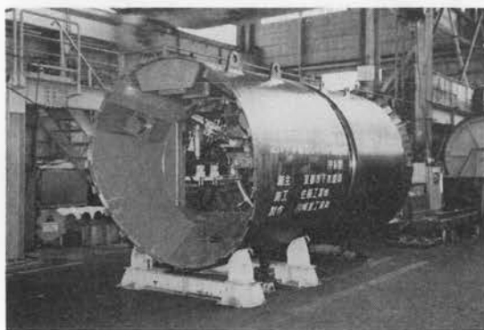
写真-26 手掘式中折型シールド掘進機
