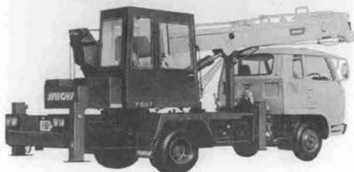
写真-3 愛知 F-507 トラッククレーン
