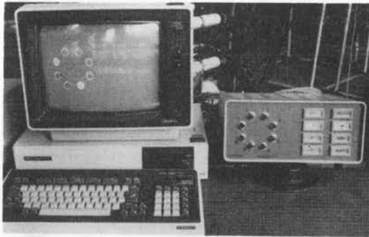
写真-3 ジャッキ制御のモニター表示
