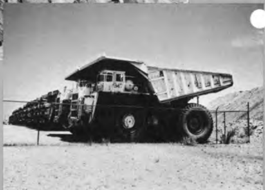
⇨ 銅鉱石運搬用の重ダンプ (手前 170t 積, 後方 100t 積)
