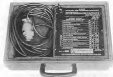
電気系統機能点検用計器 図-2 CAT D8L 電気系統点検システム
