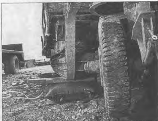
重車輛、重機械などを湿地からでも持ち上げと部品の取り付け、取りはずしにholmatro ® エアージャッキは極めて有効です。
