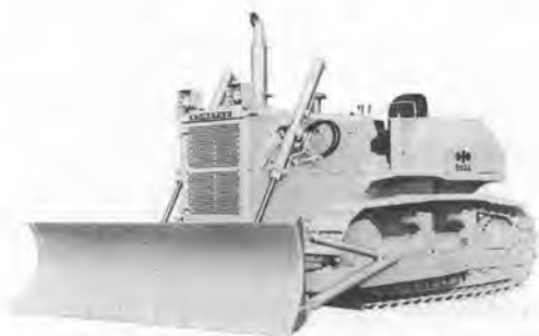
写真-2 小松 D53A-17 ブルドーザ
