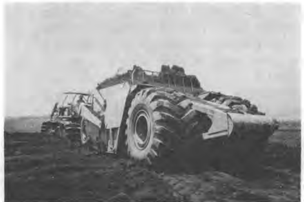
写真-4 15m 3 軟弱地用スクレーバ (国土開発 15 SBW)
