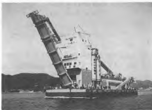
写真-16 石川島 120 m 3 /hr パッチャプラント船 (第二十七豊号)
