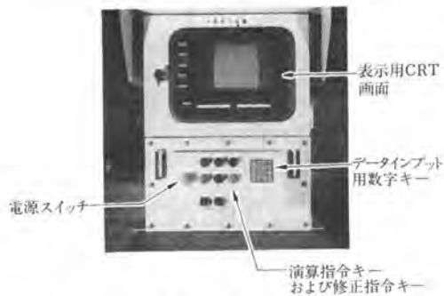
写真-1 制御操作盤
