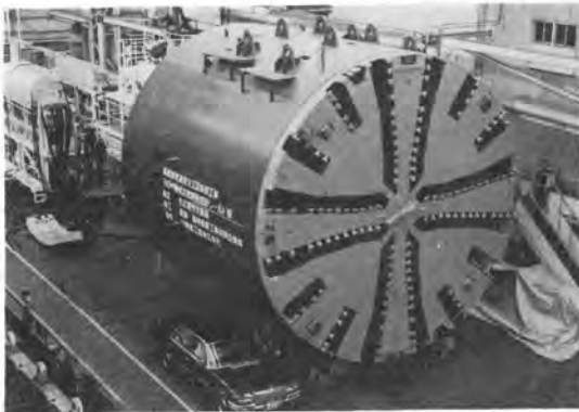
写真-3 \phi 7.45\text{ m} 加泥式シールド
