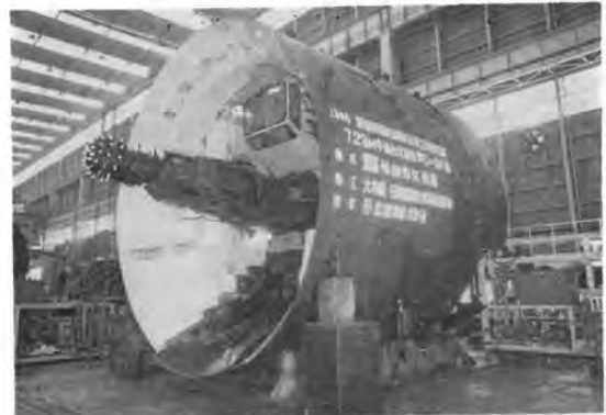
写真-5 \phi 7.23\text{ m} 軟岩用自走シールド
