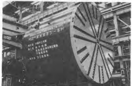
写真-1 φ11.22m 泥水加圧シールド
