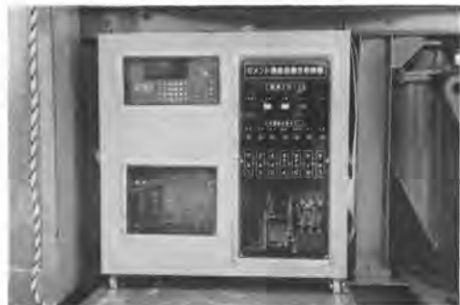
写真-1 セメント濃度分析装置の外観
