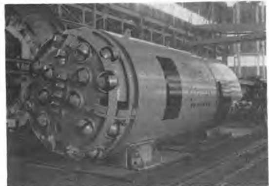
写真-6 \phi 2.6\text{ m} 全地質型トンネル掘削機
