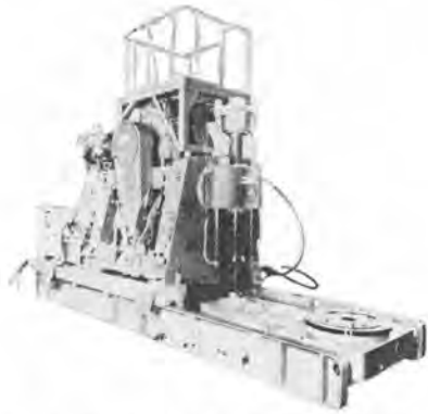
写真-1 ロータリ・スピンドル兼用型ボーリングマシン GSR-100 A
