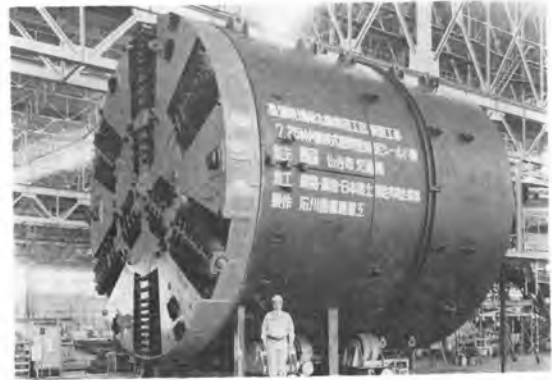
写真-4 \phi 7.25\text{ m} 加泥式シールド
