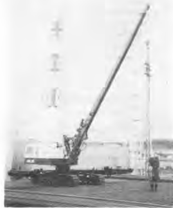
写真-5 差筋機全景
