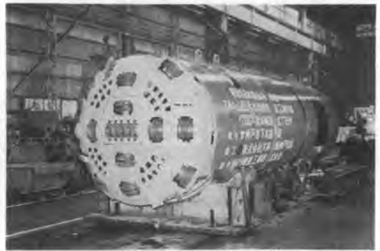
写真—7 \phi 2.0 m 流体輸送式トンネル掘削機
