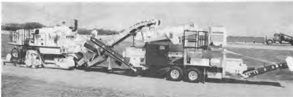
写真-1 クラッシャー、スクリーン、バグミルなどから成るコールドリサイクルシステム
