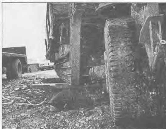
重車輛、重機械などを湿地から持ち上げと、部品の取り付け、取りはずしに holmatro ® エアーバッグは極めて有効です。
