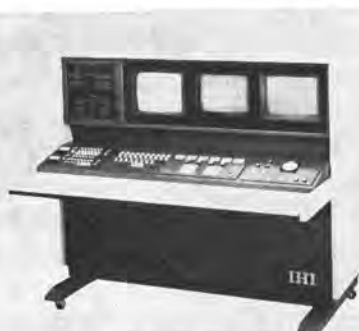
写真—2 マイコンを採用した計量操作盤
