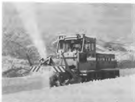
写真—8 ロータリ除雪車 (200 PS 級、 日本除雪機 HTR-201)
