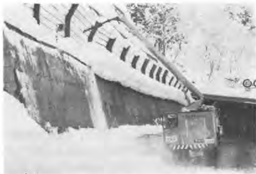
写真—10 除雪トラック（雪底処理装置付、建設省中部技術）
