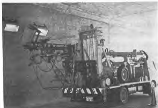
写真—5 トンネル照明清掃装置（建設省中部技術）
