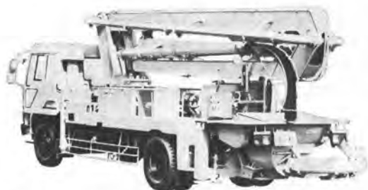
写真-2 三菱重工業製 DC-A 1000 BR コンクリートポンプ車
