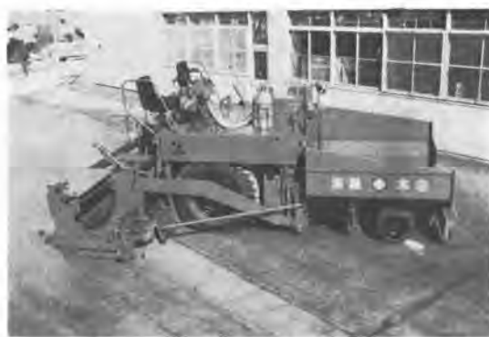
写真-1 タイヤ式アスファルトフィニッシャ (2.5~4.5 m 級)
