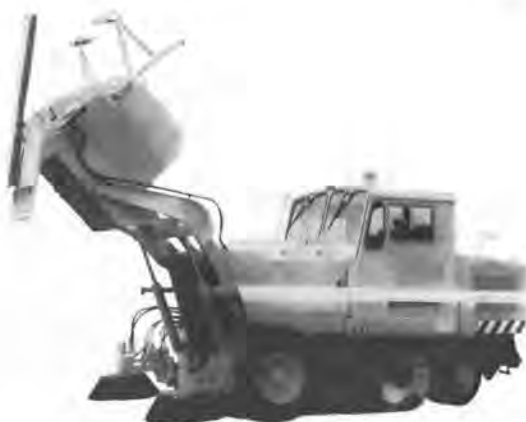
写真—3 路面清掃車（フロントリフトダンプ型 ブラシ式、東急車輛 SW 2 Z 2）
