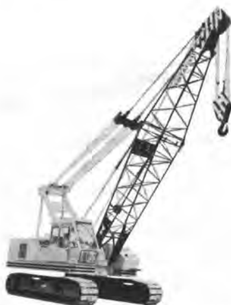
写真-6 日立 KH 125-3 油圧式クローラクレーン
