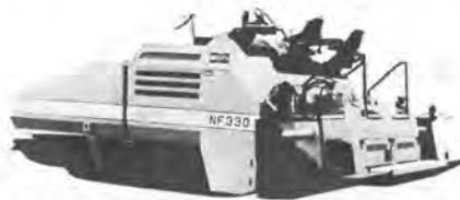
写真-2 クローラ式アスファルトフィニッシャ (2.5~5.5 m 級)
