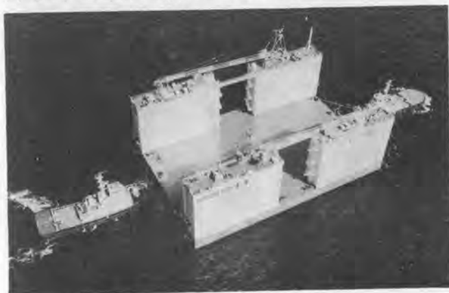
写真-1 ケーソン製作用作業台船「太平洋号」
