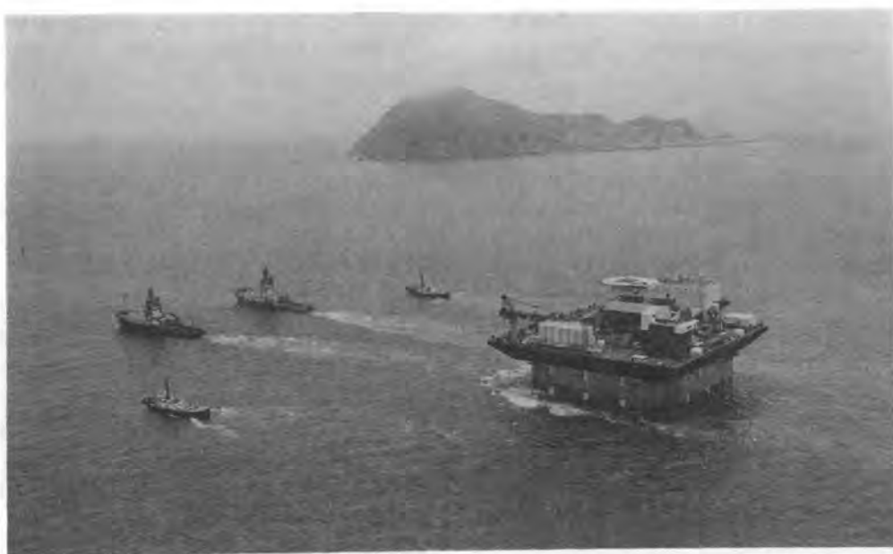
写真—1 伊勢湾を北極海に向けて曳航される Super CIDS "Glomar Beaufort Sea I"
