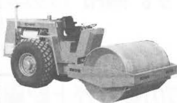
BW212 (BW213) 重量 8,880kg 起振力 16.9t 転圧巾 2,100mm
