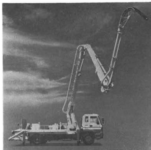
写真-7 石川島 IPF 110 B-7 E 21 コンクリートポンプ車
