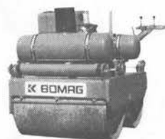
BW75S 重量 950kg 起振力 4.0t 転圧巾 750mm
