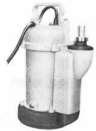
写真-4 桜川 UK-40 口 径: 25 mm 最高揚水揚程: 10 m 残水水位: 2 mm 電動機出力: 0.4 kW
