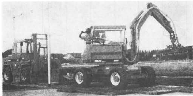
写真-4 ブロック設置機械 → （真空吸引式）
