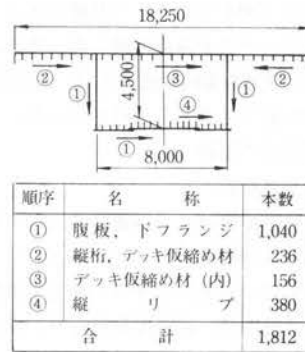
図-5 ボルト締付順序
