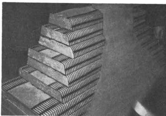
写真-1 テンサーによる盛土補強模型
